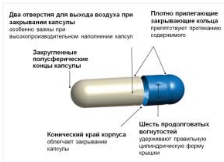
Рис. 7. Конструкция капсулы Coni-Snap® (Capsugel, Бельгия)
