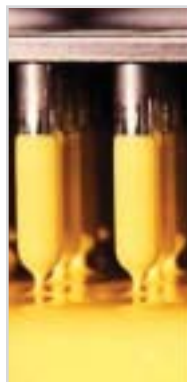
Рис. 5. Производство твердых капсул с помощью метода погружения (R & J Engineering Corporation, Канада)
