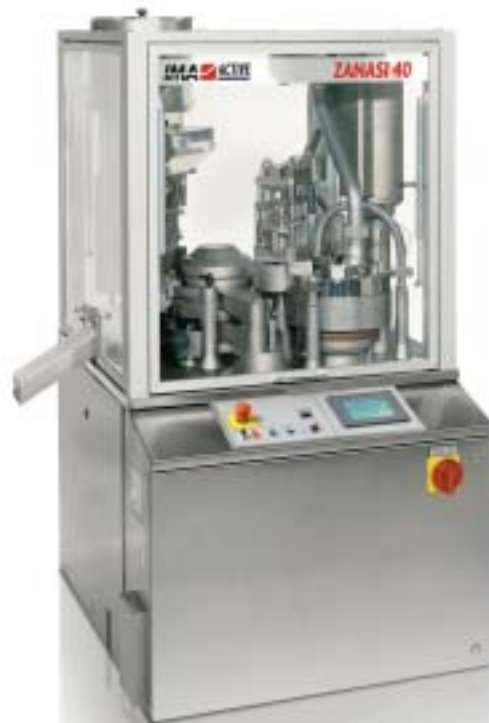
Рис. 5. Машина для наполнения капсул ZANASI 40
