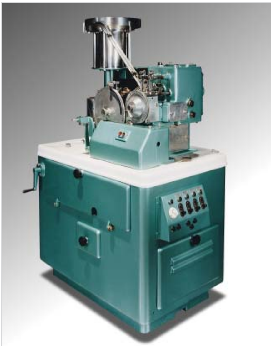
Рис. 2. Первая в мире полностью автоматическая машина LZ 57 для наполнения капсул
