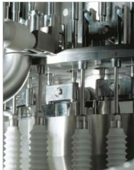
Рис. 3. Ориентирование капсул и дозирование в машинах непрерывного цикла
