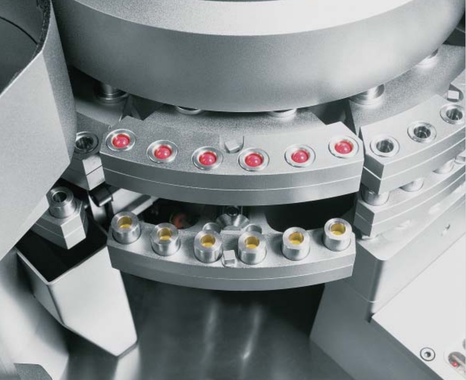
Рис. 1. Блоки транспортировки капсул
