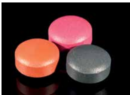
Рис. 5. Таблетки, покрытые при температуре продукта 47 °С оболочкой, содержащей 15 % ПЭГ 6000
