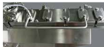
Закрытый корпус гранулятора VCG 25, имеющий гибкие вставляемые порты и зону добавления жидкости
