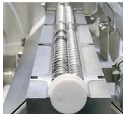
Открытый корпус с фронтальным видом на шнеки, которые являются центральной частью и зоной обработки гранулятора VCG 25
