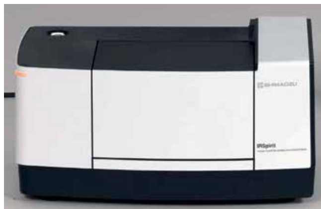
Фото № 6. Спектрофотометр ИК-диапазона с преобразованием Фурье модели IR Spirit производства корпорации SHIMADZU
