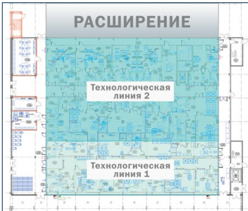
Рис. 2. Схема расположения оборудования на заводе по производству твердых лекарственных форм компании «АстраЗенека»
