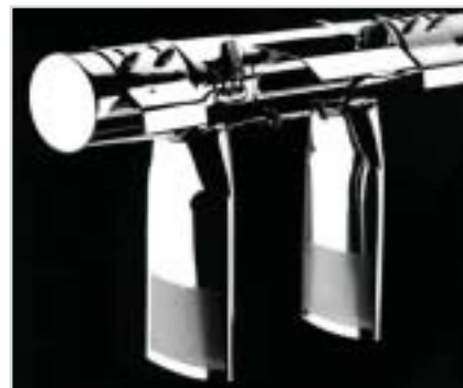
Рис. 3. Перфорированные лопасти установки GS HT-HE-HP производства компании IMA
