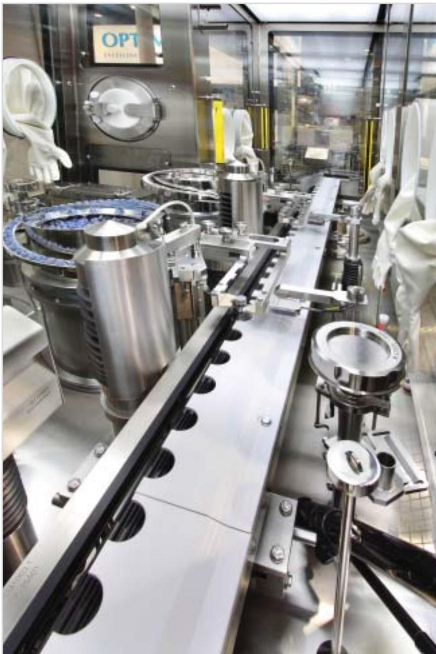
Комбинированная система, состоящая из KUGLER Linoline и разнообразных модулей INOVA, демонстрирует, как можно универсальным образом и в асептических условиях обрабатывать бутылочки, флаконы, конические крышки, навинчивающиеся крышки и пипетки
