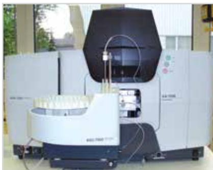
Фото № 4. Атомно-абсорбционный спектрометр SHIMADZU модели AA-7000
