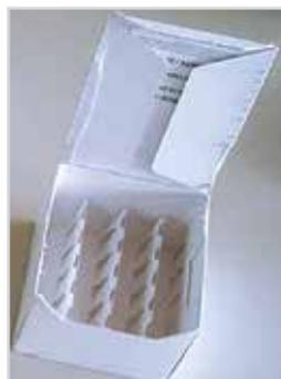
В данном случае верхняя крышка склеивается в трех местах с коробкой (две точки нанесения клея находятся на откидных клапанах, третья – на боковой стенке). При открытии крышки происходит отрыв откидных клапанов от самой упаковки по заранее перфорированному или полувыврезанному овальному отверстию. Таким образом, на откидных клапанах визуально видно вскрытие упаковки. Данный вариант защиты достаточно широко применяют многие фармацевтические компании.
