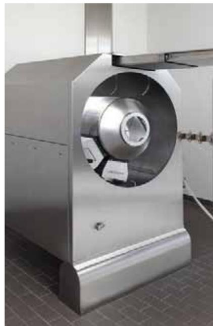
Установка нового коатера BFC TriPan в сервисном центре компании L.V. Böhle обеспечивает заказчиков ультрасовременным оборудованием для испытаний процесса нанесения оболочки. Коатер BFC TriPan может функционировать с тремя барабанами, позволяющими производить серии объемом от 7 до 75 л. Замена барабана коатера производится менее чем за 30 мин.
