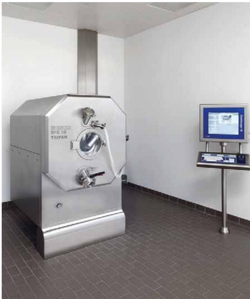
нанесения оболочки. Коатер BFC TriPan может функционировать с тремя барабанами, позволяющими производить серии объемом от 7 до 75 л. Замена барабана коатера производится менее чем за 30 мин.
