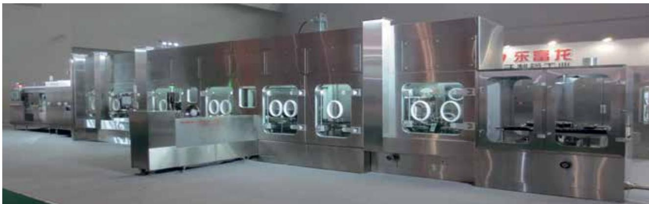
Усовершенствованный дизайн рабочих блоков позволяет осуществлять их монтаж сквозь стену. Зона технического обслуживания целиком отделена от зоны асептического процессинга во избежание перекрестного загрязнения и несанкционированного воздействия персонала на продукт.
