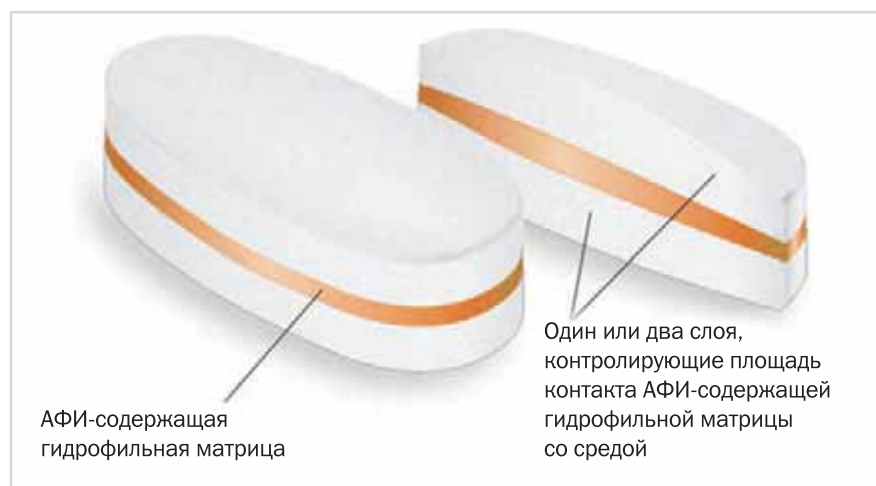
Рис. 3. Система GEOMATRIX [по материалам SkyePharma]
