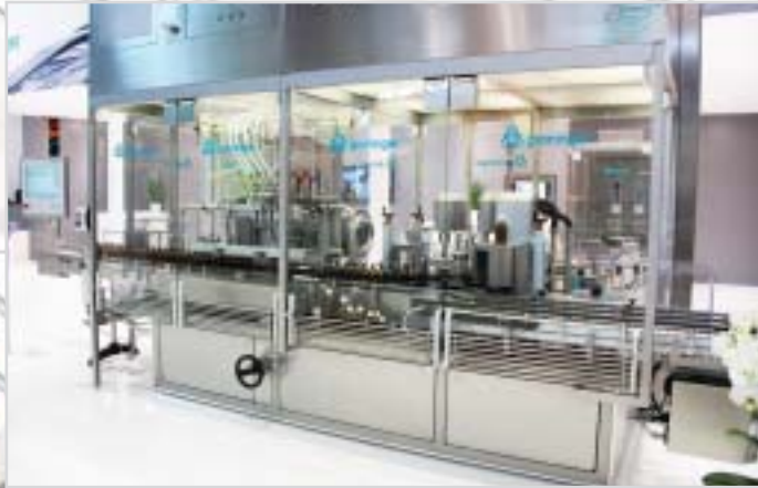
Линия FlexPro 50 компании groninger для кассетированных, предварительно стерилизованных контейнеров (или объектов) в изоляторном исполнении
