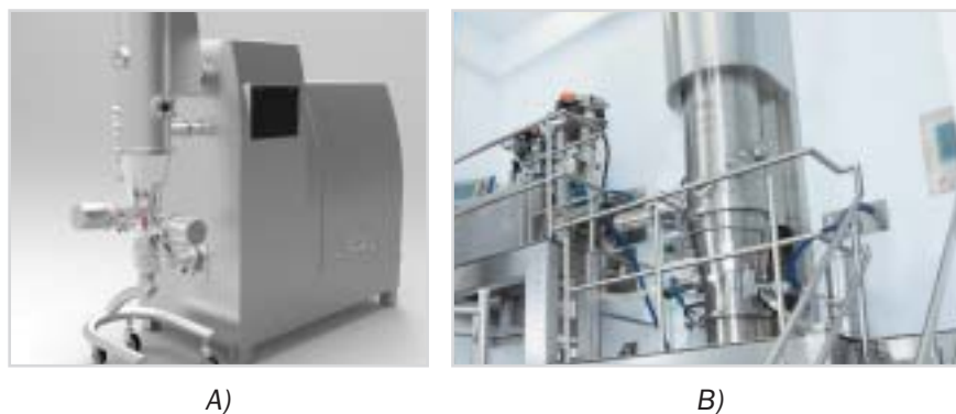
Рис. 2. Оборудование компании GEA (Германия): А) лабораторная установка псевдооживленного слоя AirConnect™; В) промышленная установка PRECISION-COATER™
