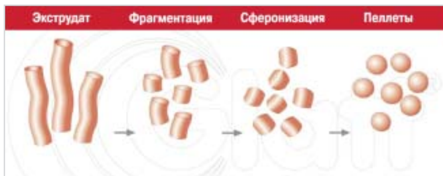
Рис. 3. Схематическая иллюстрация преобразования экструдированного материала в пеллеты [адаптировано с сайта компании Glatt (Германия)]
