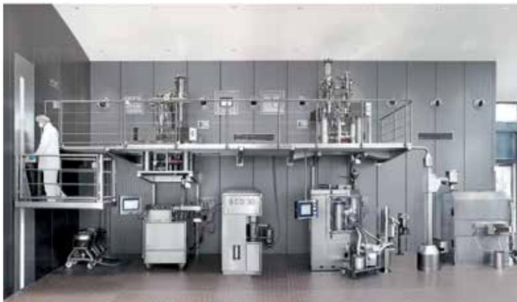
**Установка непрерывного производства**
