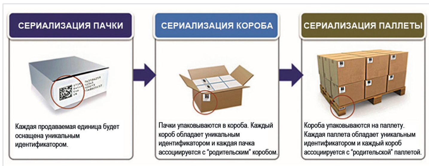
Рис. 2. Применение уникальных идентификаторов упаковок разных уровней – от первичной до поддона – для создания обобщенных данных в фармацевтической цепочке поставки
