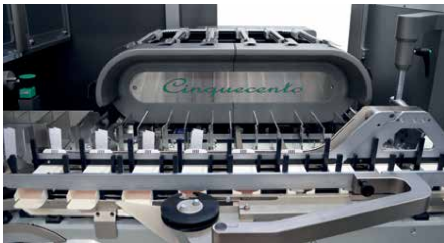
Integra 520 V – самая быстрая роботизированная линия фасовки в блистеры из всех, производимых компанией Marchesini Group
