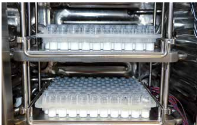
Рис. 4. Установленные в гнезда флаконы в лиофильной сушке для пилотного производства
