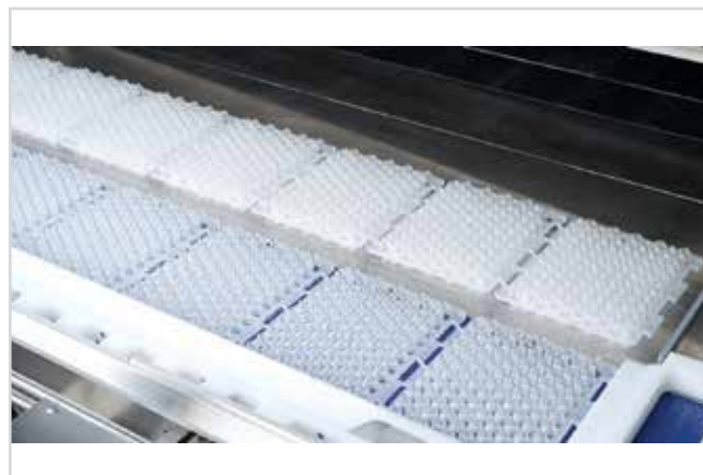
Рис. 2. Помещенные в гнезда флаконы во время автоматической загрузки / выгрузки
