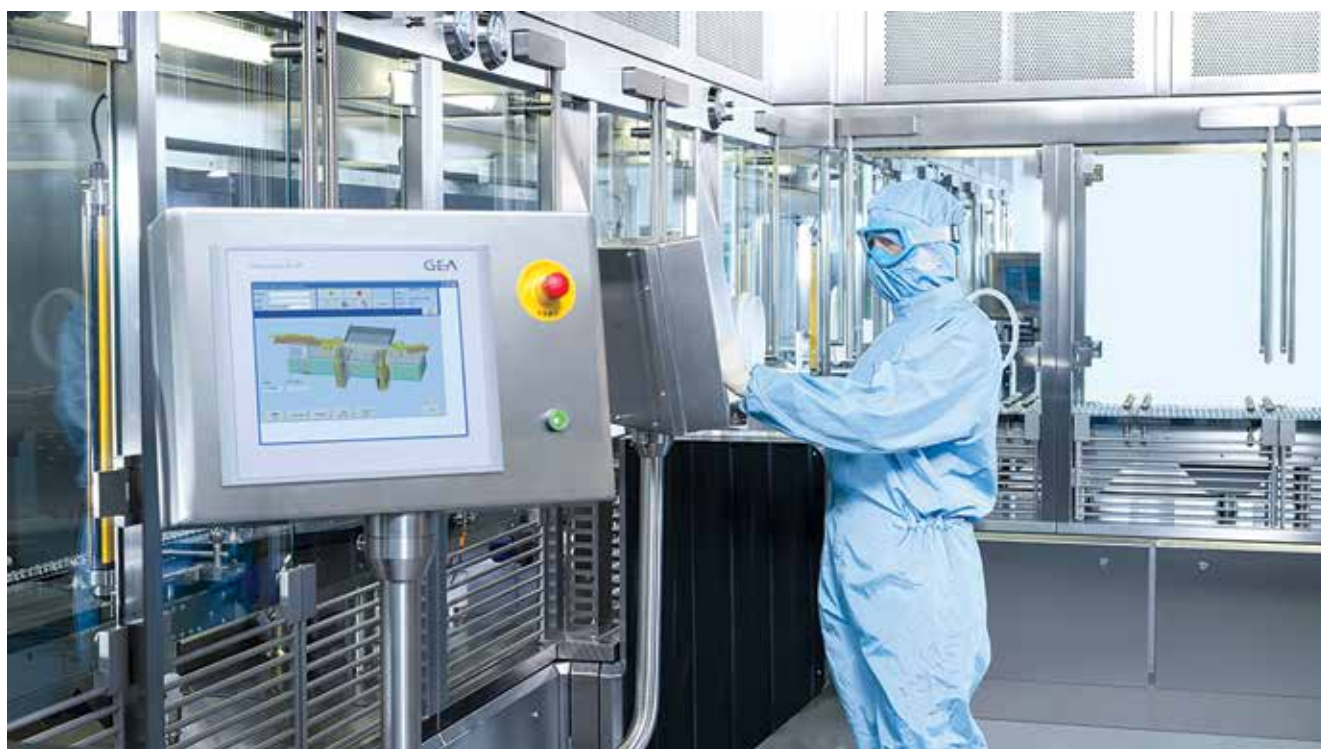
Рис. 3. Система загрузки для установленных в гнезда флаконов или поддонов
