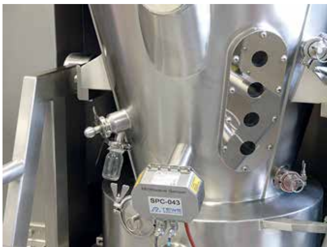
Датчик для измерения влажности, встроенный в сушилку типа Glatt WS-Combo
