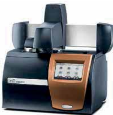
Рис. 1. Дифференциальный сканирующий калориметр Discovery DSC 2500 производства компании TA Instruments
