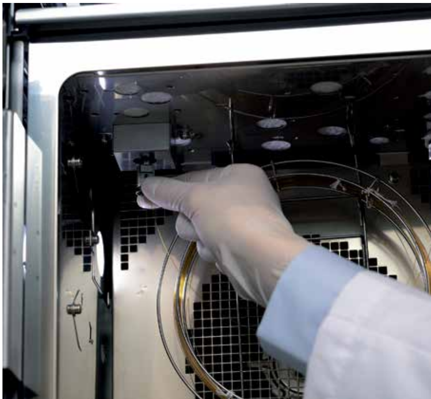
Фото № 2. Замена колонки с помощью устройства по технологии ClickTec на хроматографе модели GC-2030
