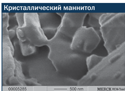
Рис. 5. СЭМ-изображение поверхности частиц маннитола (кристаллический маннитол и Parteck® M200)
