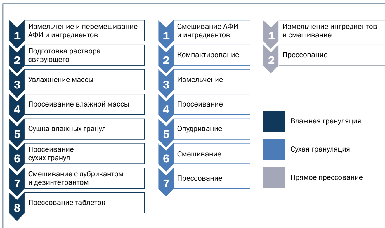
Рис. 1. Схематическое изображение стадий разных технологий прессования таблеток
