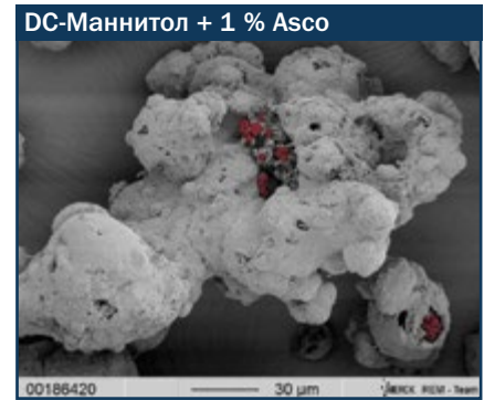
Рис. 3. Адсорбция АФИ частицами маннитола «Parteck® M200 + 1% Asco» и «DC-Маннитол (PC) + 1% Asco»
