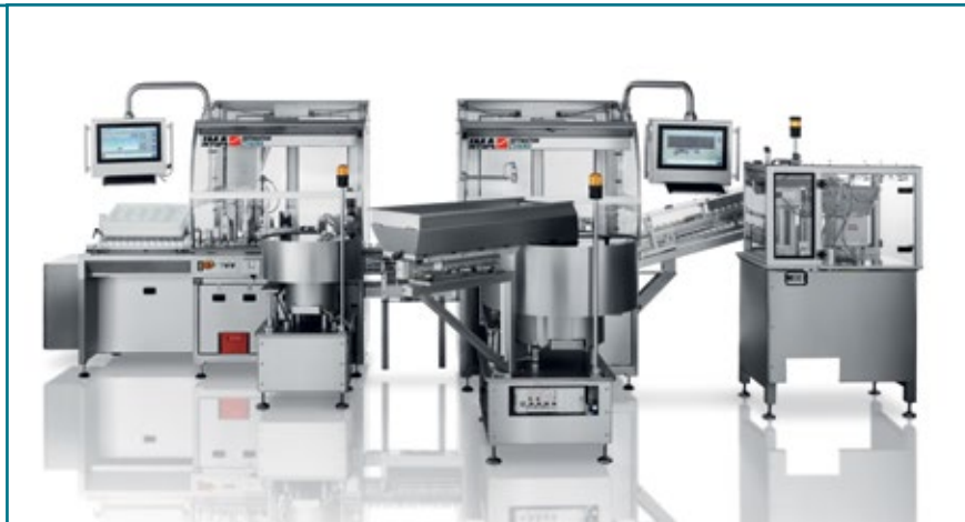
Высокопроизводительная машина для сборки аэрозольных ингаляторов, продуцирующих «мягкий» аэрозоль
