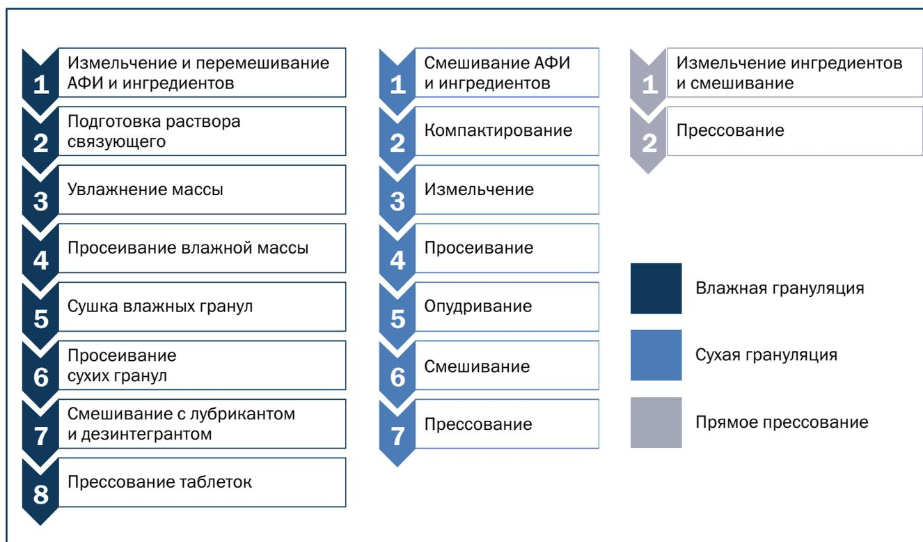
Рис. 1. Схематическое изображение стадий разных технологий прессования таблеток
