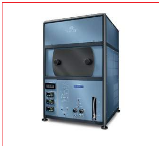
Рис. 2. Паросорбционный анализатор VTI-SA+
