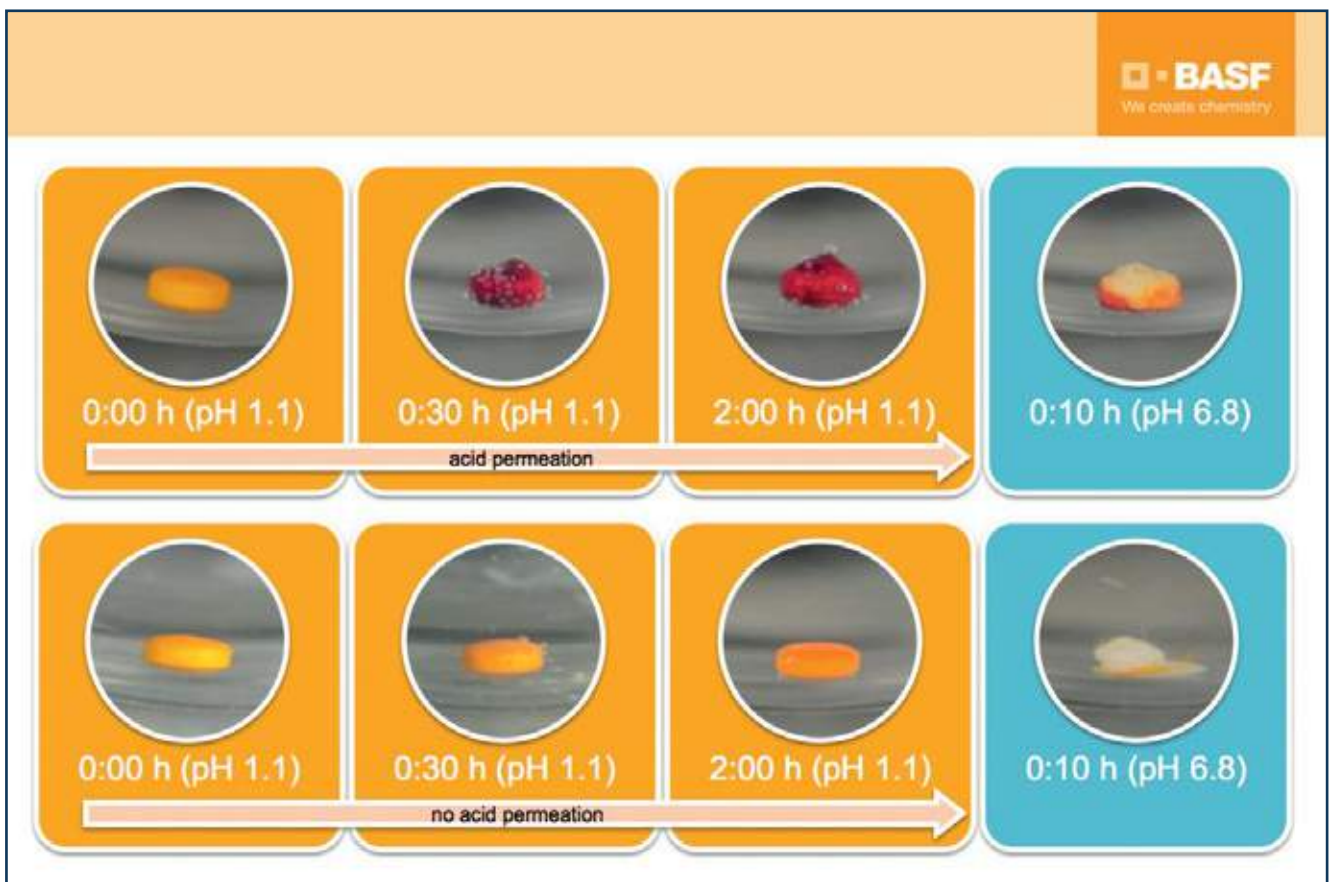
Рис. 1. Проникновение кислоты при уровне покрытия 3 мг / см 2 (верхний ряд), отсутствие проникновения кислоты при уровне покрытия 6 мг / см 2 (нижний ряд) и соответствующее влияние на распадаемость после изменения pH (на синем фоне)
