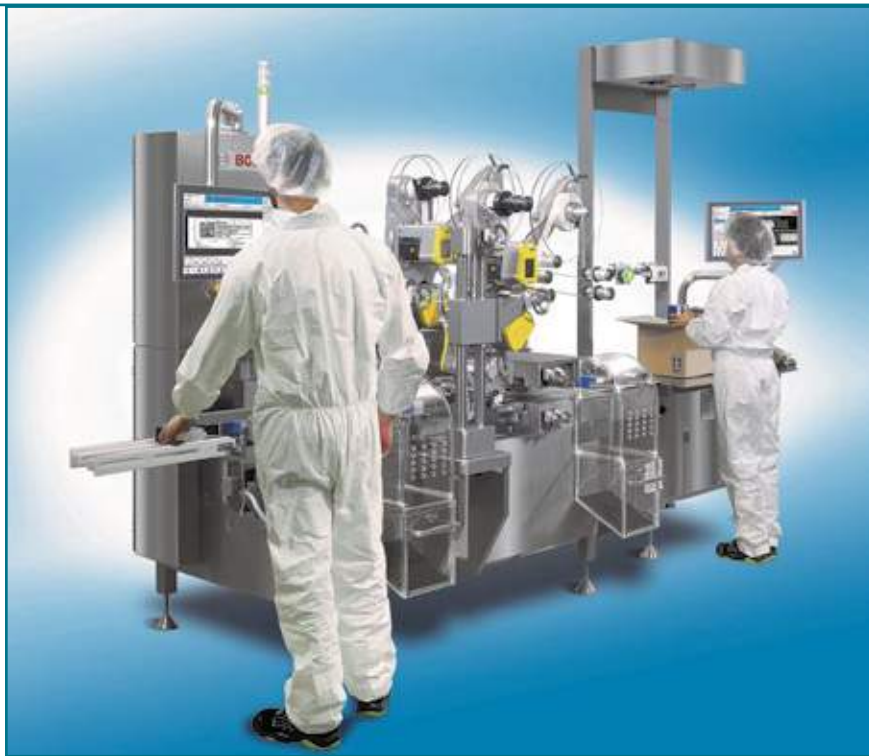
Модуль CPS 1900 WTE с функцией контроля первого вскрытия и встроенными весами
