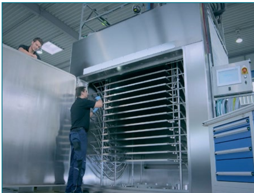
Двухуровневый производственный участок позволяет конструировать и тестировать сублимационные сушилки прямо на площадке Optima Pharma. На выставке АСНEMA компания представит новую гибкую и компактную сублимационную сушилку CS
