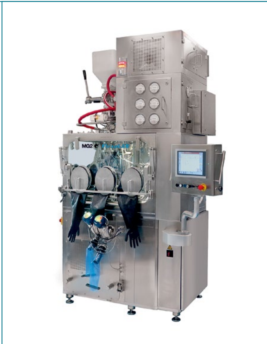
Капсулозаполнительная машина MG2 модели FlexaLAB в изоляторном исполнении с уровнем защиты OEB 5
