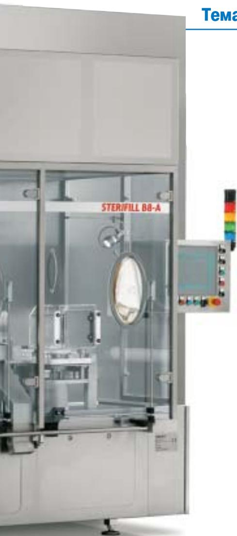
Большим преимуществом для производства по выпуску лекарственных препаратов в ампулах различного размера является то, что перенастройку оборудования можно выполнять очень быстро и без использования специальных инструментов,
