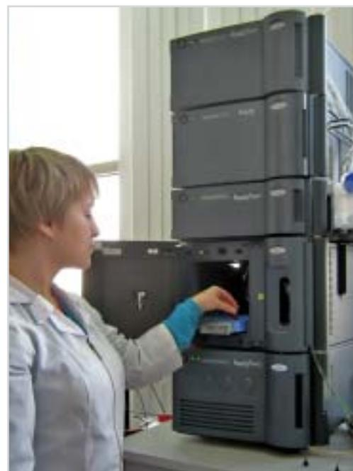
Рис. 2. Acuity UPC<sup>2</sup> – первая аналитическая сверхкритическая хроматографическая система класса UPLC
