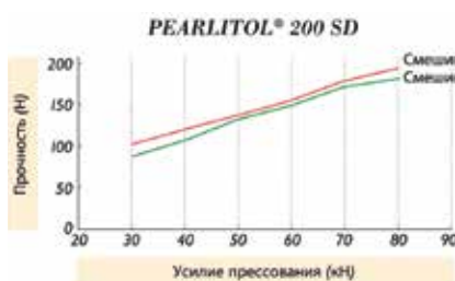
Рис. 8. Прочность при различном времени опудривания со стеаратом магния
