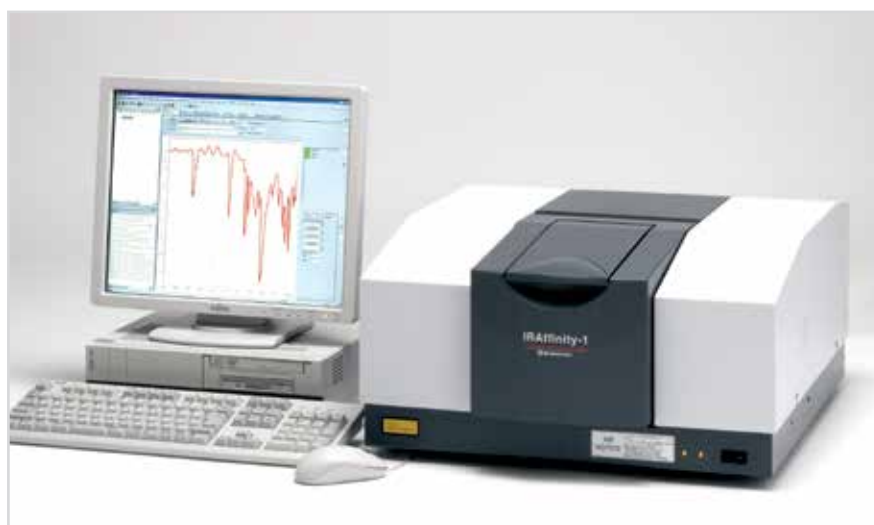
Фото № 2. ИК-Фурье спектрофотометр SHIMADZU модели IRAffinity-1
