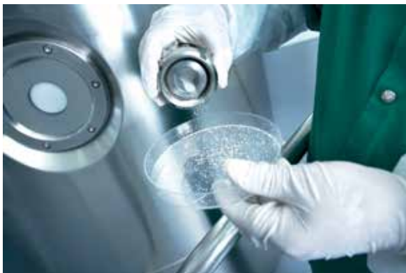
Создание пеллет с помощью метода «движимого воздухом» слоя
