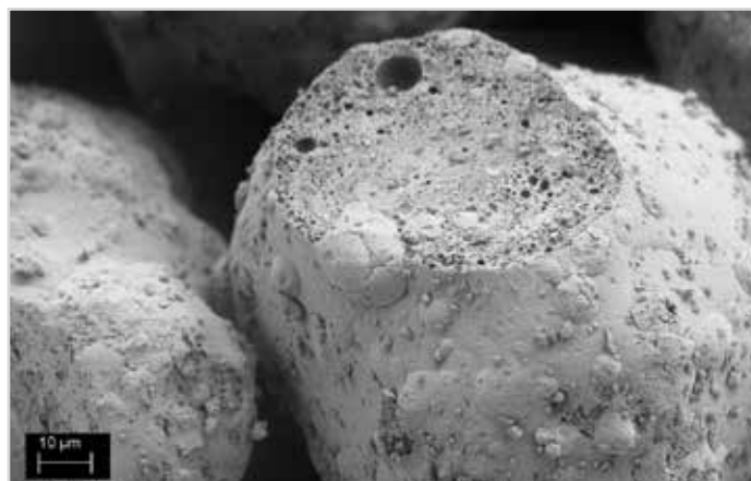
Рис. 1. Поверхность среза инкапсулированного продукта, видимая в электронный микроскоп
