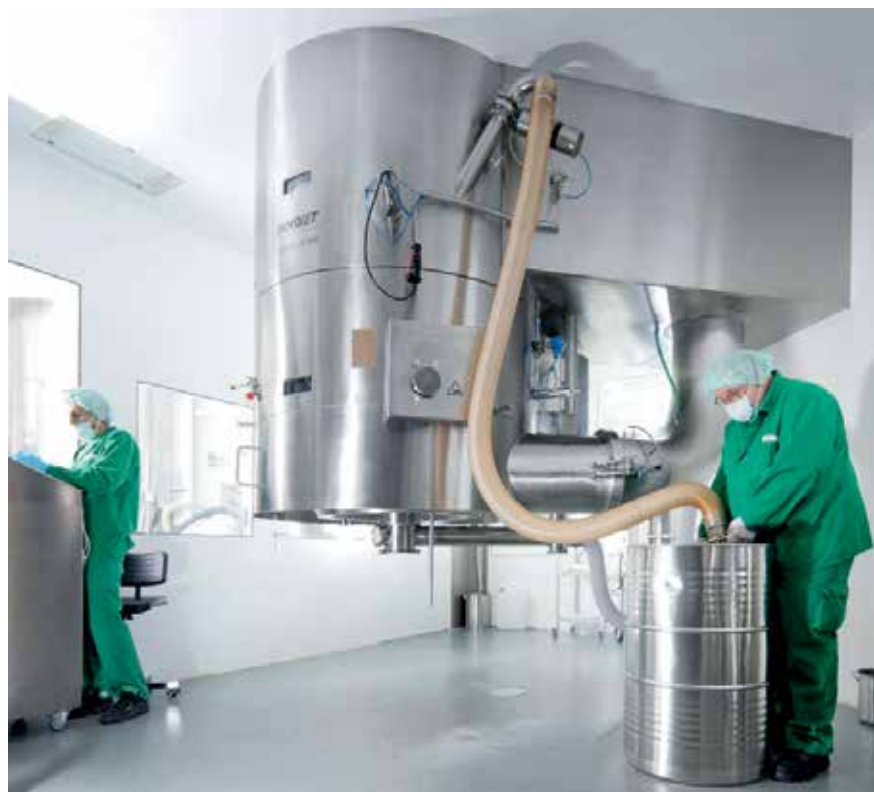
Производственная установка VENTILUS® V 800 от Romaco Innojet в процессе эксплуатации на заводе компании Acino Pharma в Лисберге (Швейцария)
