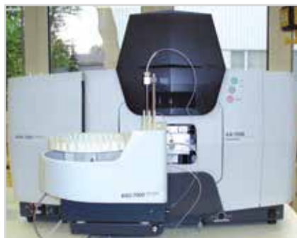
Фото № 4. Атомно-абсорбционный спектрометр SHIMADZU модели AA-7000
