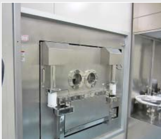
Установка Lyo-5 (SIP, CIP). Дверь камеры со встроенной автоматической «пицца»-дверью
