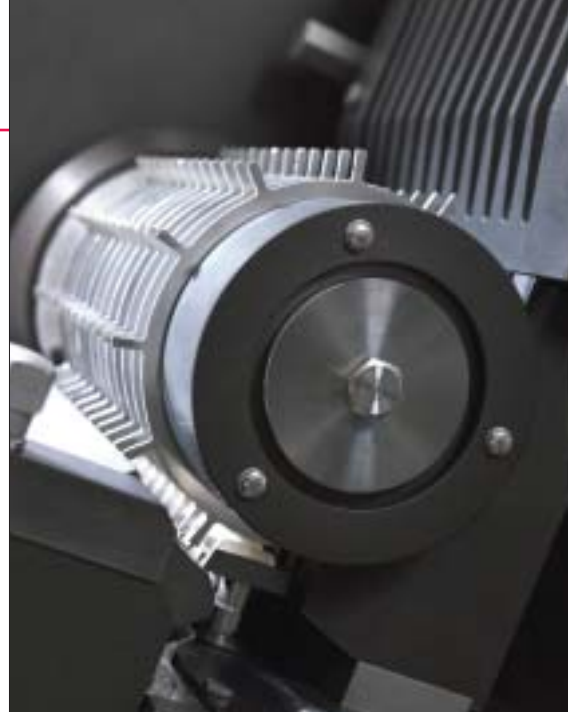
Рис. 3. Система проверки веса всех 100 % капсул на выходе
