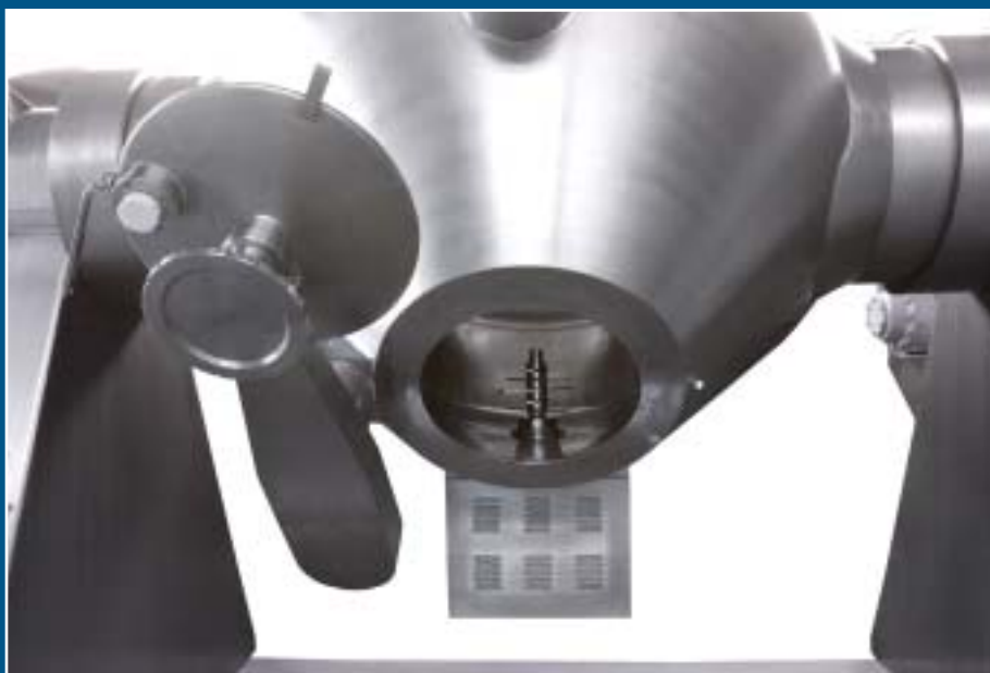
Сушилка CRIOX с открытым люком. Внутри видна установленная в камере дробилка
