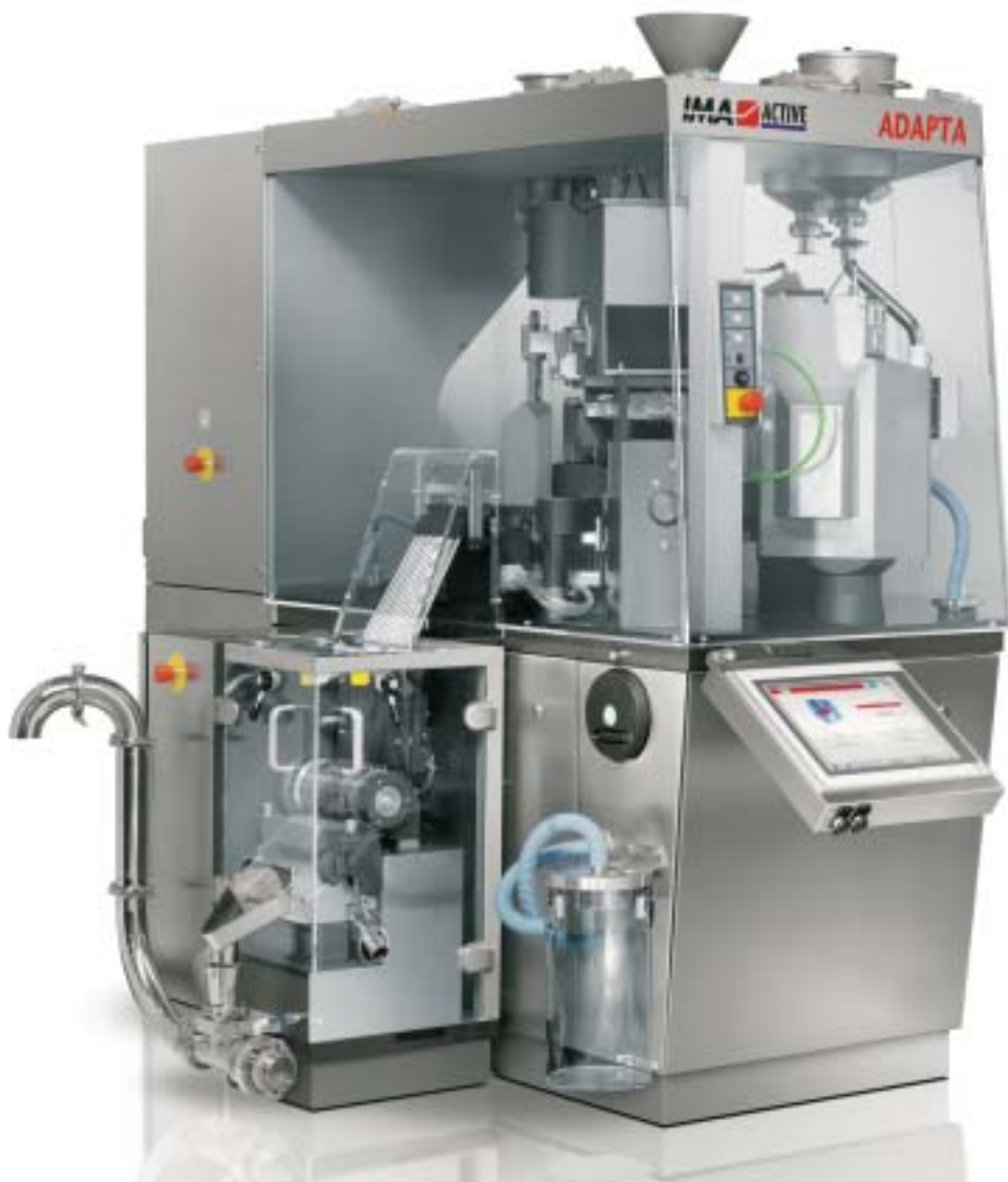
Рис. 1. Машина ADAPTA с системой полного контроля технологического процесса (TPC – Total Process Control), осуществляющая «онлайн» проверку веса всех 100 % капсул
