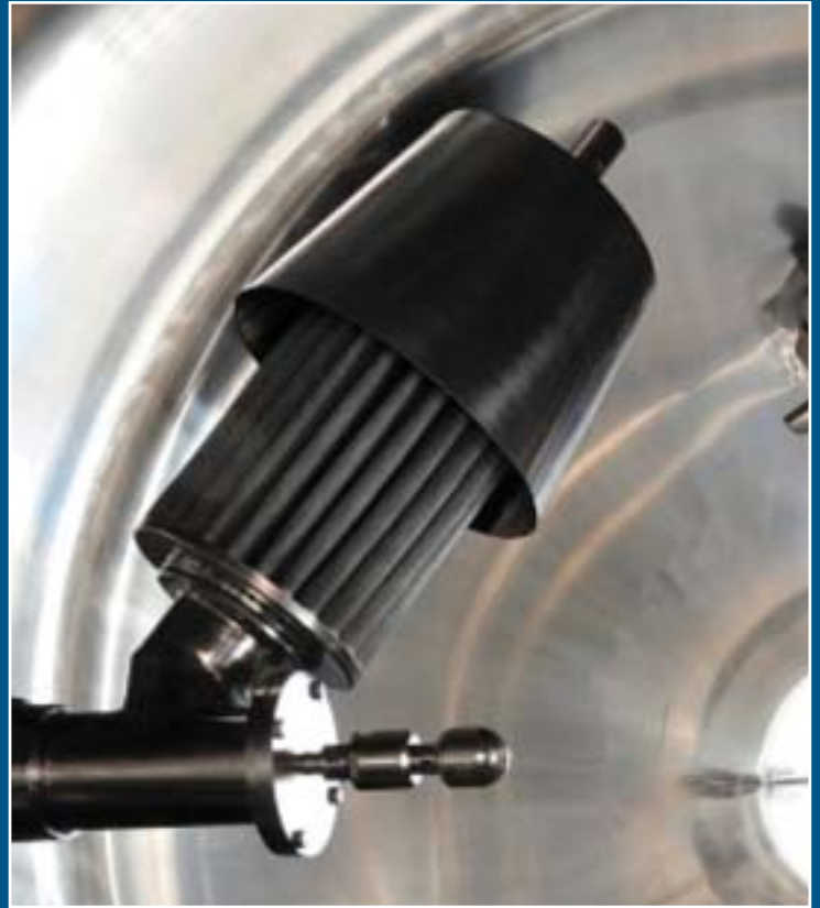
Внутренний картриджный фильтр с установленной на нем моющей CIP-головкой
