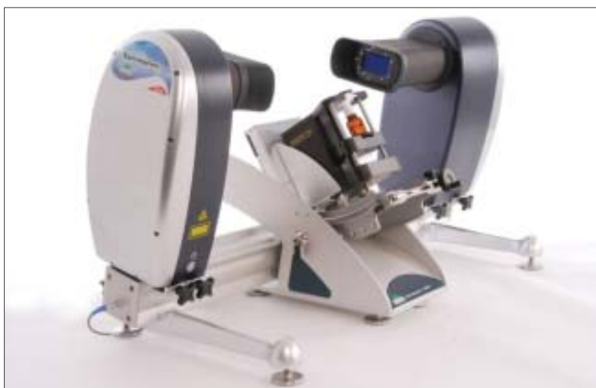
Рис. 2. Система Spraytec для характеристики назальных спреев, Malvern Instruments (UK)
