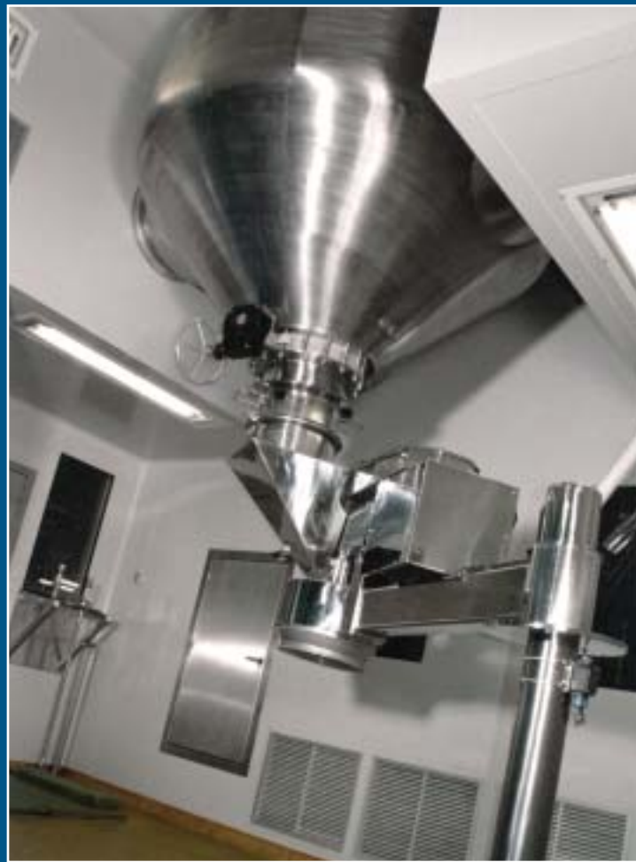
Раздельная установка CRIOX в чистой / технических зонах с модулем автоматической загрузки
