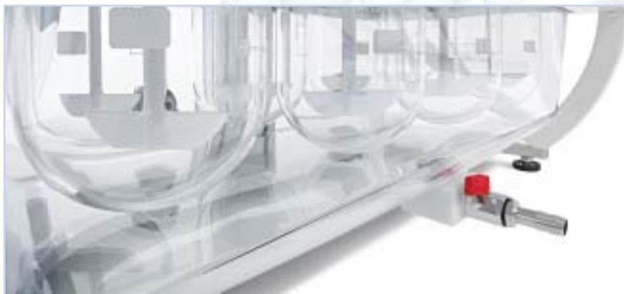
Рис. 1. Apparatus 2 (с лопастью)
