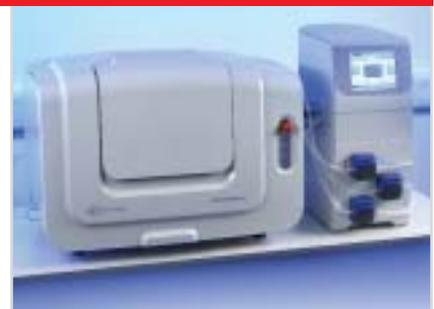
Полностью закрытая платформа XRS 20 с автоблокировкой обеспечивает безопасность для оператора и одновременно защищает светочувствительные компоненты среды. ■
