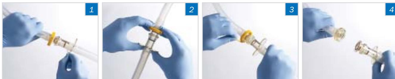
Рис. 2. Четыре простых этапа использования стерильного дисконнектора Kleenprak™: 1). Удалить белую защищающую от срабатывания манжету. 2). Сблизить детали нажатием до фиксации. 3). Удалить желтую защищающую от разъединения манжету. 4). Повернуть (против часовой стрелки) и разъединить.
