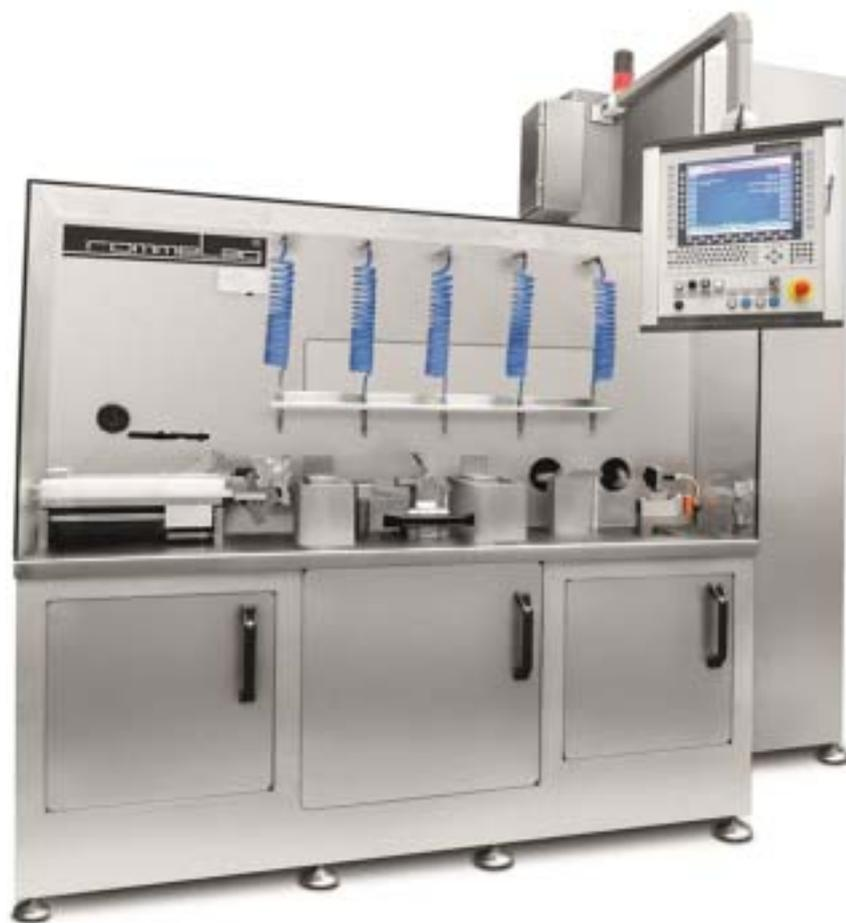
VIM – инспекционная машина для проверки флаконов
