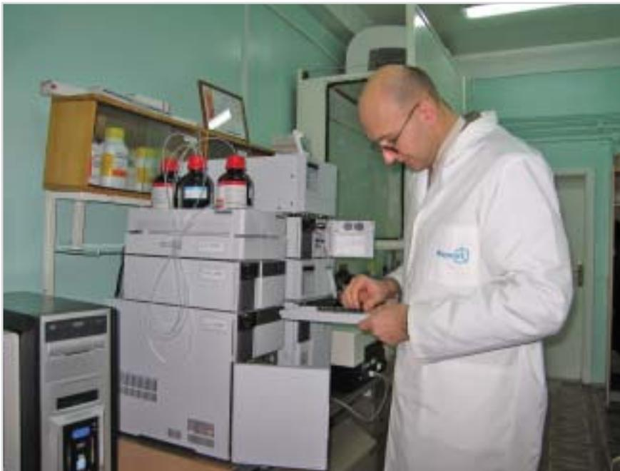
Фото № 2. Жидкостный хроматограф SHIMADZU модели LC-20 в лаборатории фармацевтического завода «Фармак»
