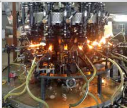
Установка по производству флаконов в работе
