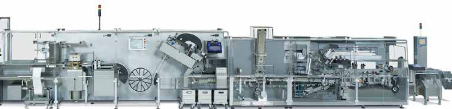
Рис. 2. Машины серии CP500: перенастраиваемые линии высокой производительности для упаковки блистеров, которые работают с нестандартной продукцией, такой как блистеры больших размеров, блистеры alu-alu или термоусадочные блистеры специальных форм, а также с упаковкой с глубиной ячейки до 45 мм, блистерами многоступенчатой холодной формовки и с многокомпонентной продукцией
