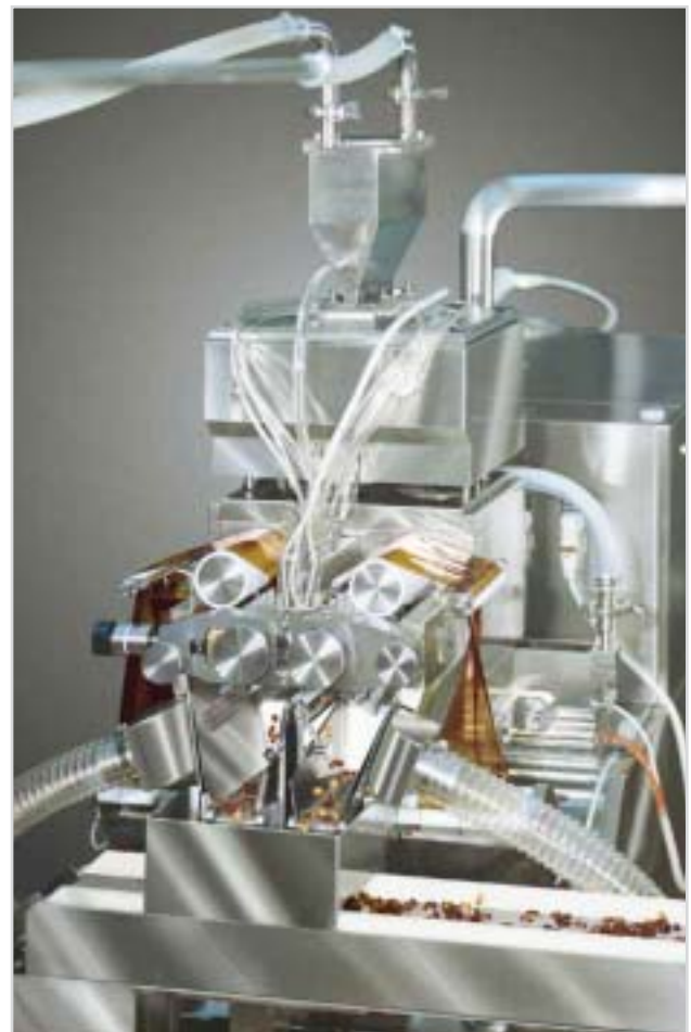
Рис. 3. Процесс капсулирования (Pharmagel Engineering SPA, Италия)
