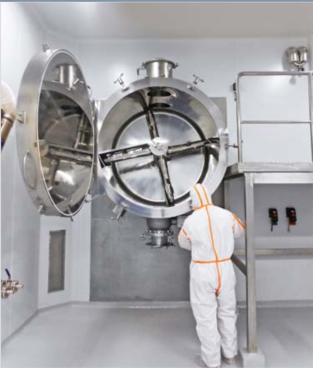
Установка сушилки CosmoDry® в чистой комнате
