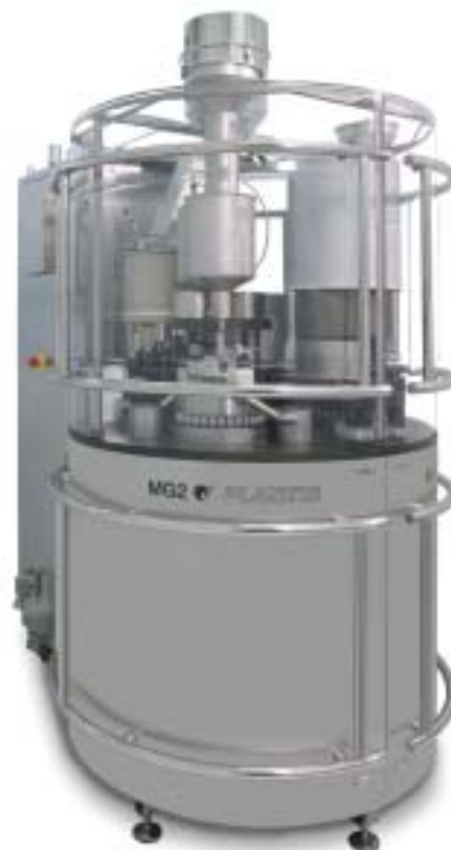
Рис. 8. Капсулонаполняющая машина, позволяющая дозировать в твердую желатиновую капсулу жидкости или жидкости в комбинации с пеллетами, капсулами меньшего размера и т. п. (Planeta, MG2, Италия)
