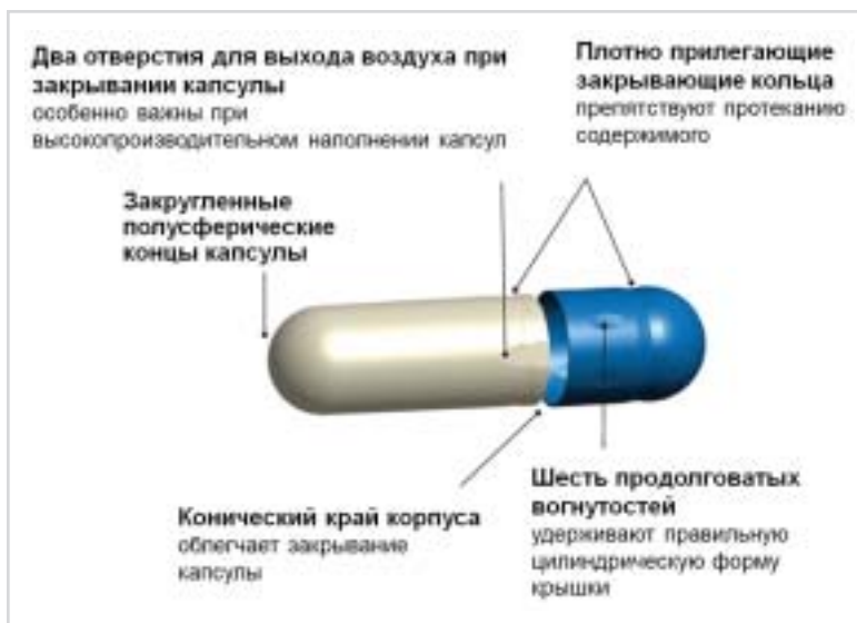
Рис. 7. Конструкция капсулы Coni-Snap® (Capsugel, Бельгия)
