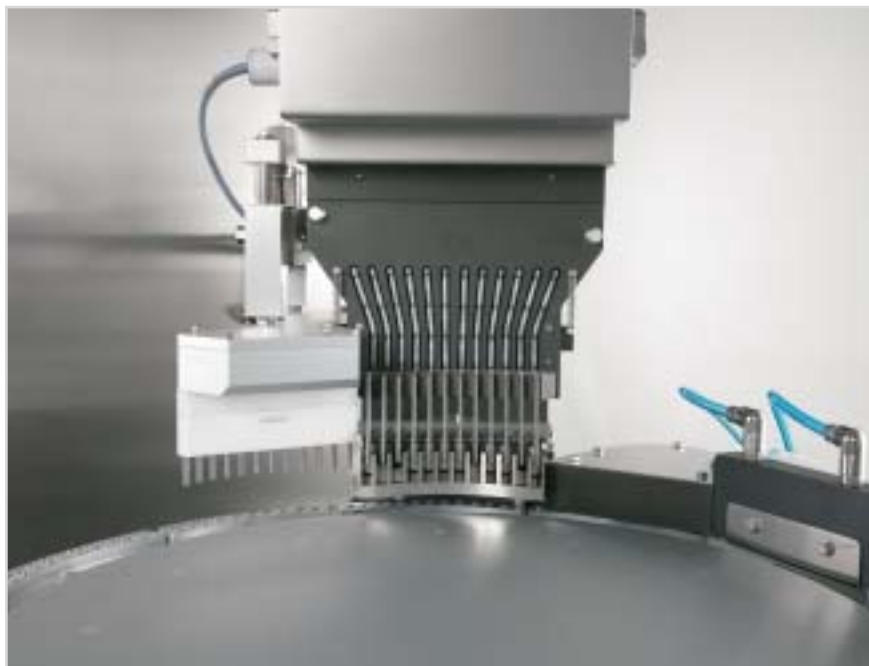
Рис. 6. Машина PRACTICA – загрузка пустых капсул
