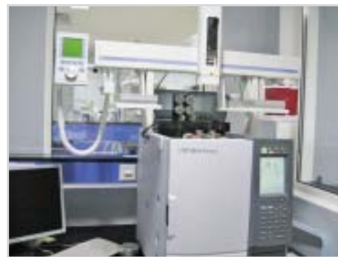
Фото № 7. Газовый хроматограф SHIMADZU модели GC-2014 с универсальным автоинжектором AOC-5000
