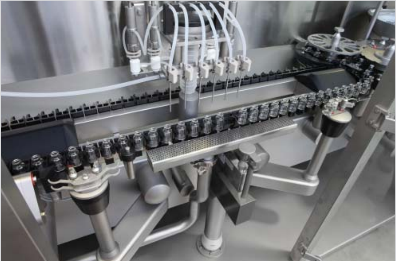
Асептическая машина Stery Capsy для розлива и укупорки инъекционных лекарственных форм
