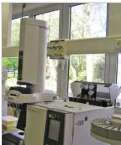
Фото № 6. Газовый хроматограф SHIMADZU модели GC-2014 с парофазным автоинжектором HT-200H
