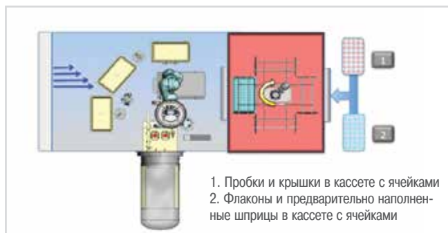
Рис. 1. Новая концепция роботизированного изолятора для работы без перчаток (источник: Fedegari Group)
