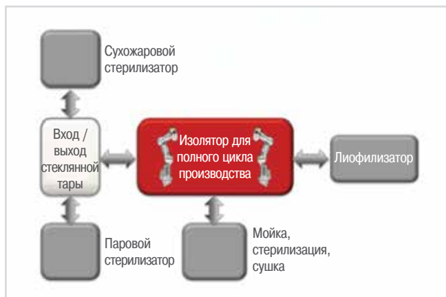
Рис. 2. Концепция кластерного инструмента (источник: Fedegari Group)
