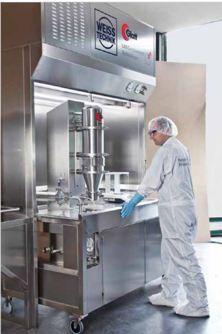
Рис. 5. Установка рабочего стола с размещенной на нем сушилкой Midi-Glatt с псевдооживленным слоем в изолирующий бокс WIBObarrier
