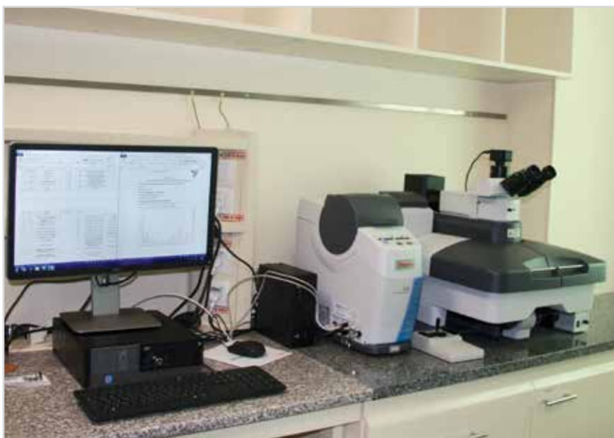
Рис. 3. Спектрометр комбинационного рассеяния света DXR Raman Microscope
