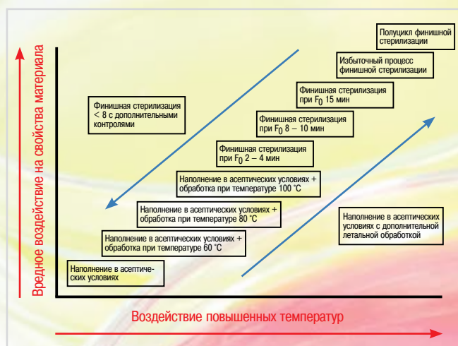
Рис. 3. Модель стерильного производства, включающая асептическое производство (AP) и финишную стерилизацию (TS). Числовые значения на рисунке приведены в качестве иллюстрации и не являются определяющими; прогресс процесса следует понимать как непрерывный
