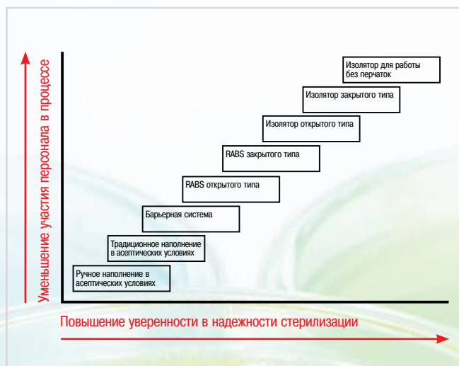
Рис. 2. Модель асептического производства. RABS – барьеры ограниченного доступа
