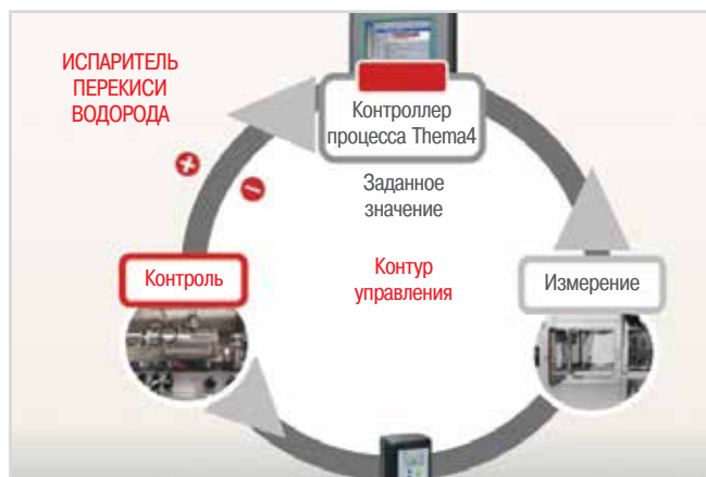
Рис. 7. Революционный испаритель перекиси водорода с контуром управления (на основе PID) (источник: Fedegari Group)
