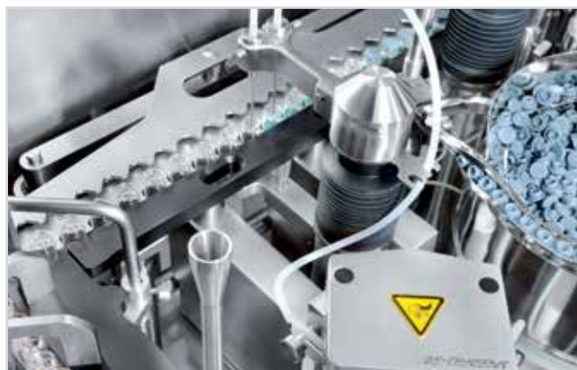
Интеграция системы 100% контроля веса с микровесами
