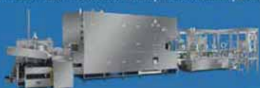
Компактная линия стерильного производства в флаконы, включая оборудования для мойки, стерилизации, розлива и закатки
