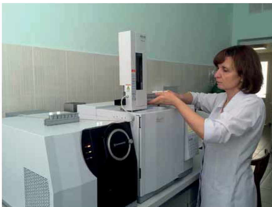
Фото № 1. Измерение на газовом хромато-масс-спектрометре модели GCMS-TQ8040 производства корпорации SHIMADZU
