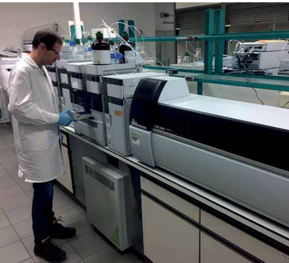
Фото № 2. Измерение на жидкостном хромато-масс-спектрометре модели LCMS-8040 производства корпорации SHIMADZU
