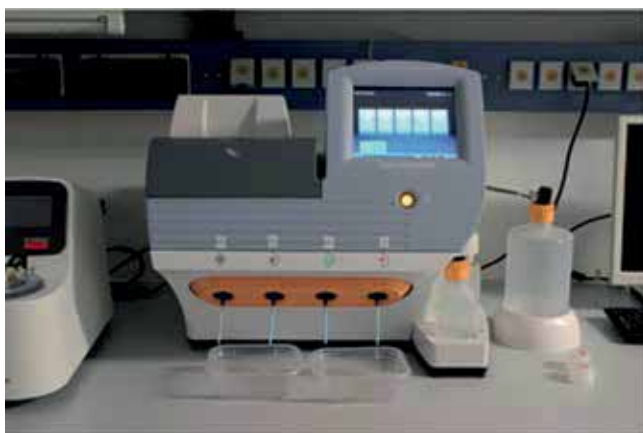
Рис. 4. Ion Torrent Personal Genome Machine® – секвенатор PGM™ (источник: лаборатория фирмы Sustasy Bioscience GmbH, Мюнхен)
