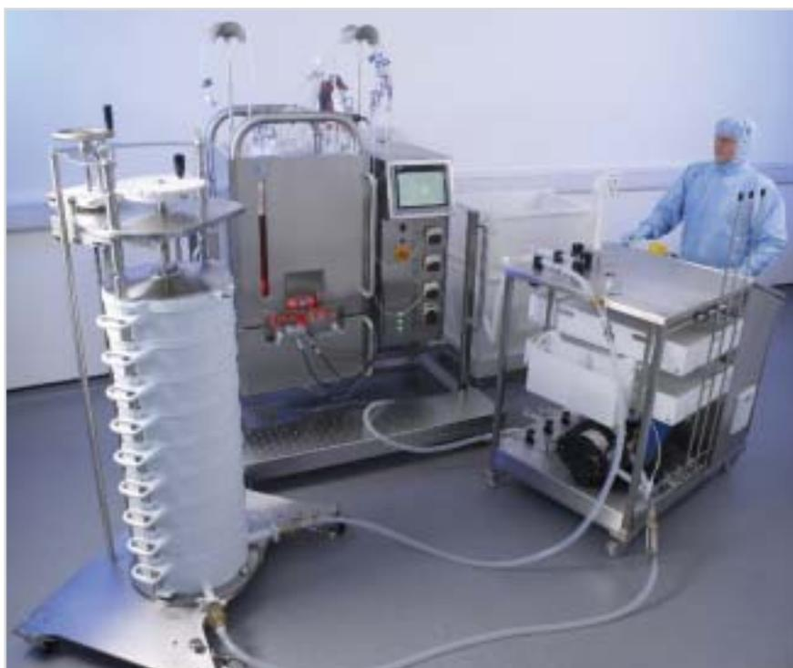
Система Allegro™ MVP-Single Use позволяет полностью автоматизировать весь диапазон операций для проведения тупиковой фильтрации
