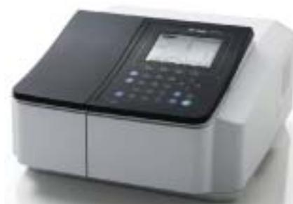
Фото № 4. Спектrophотометр УФ-видимого диапазона SHIMADZU модели UV-1800
