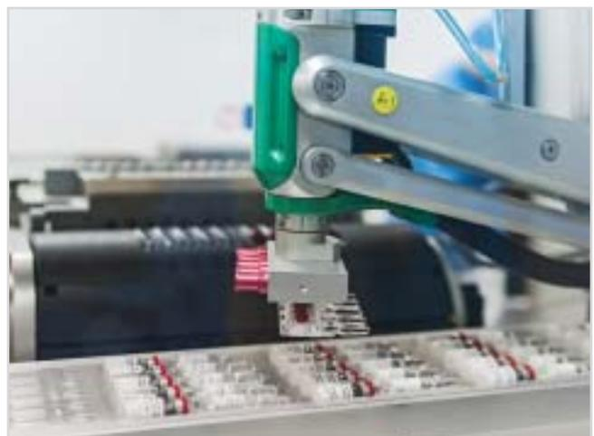
*Рис. 6. Роботизированная укладка флаконов в блистеры*
