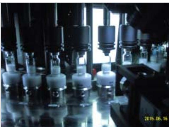
*Рис. 5. Проверка качества лиофилизата на инспекционной машине*
