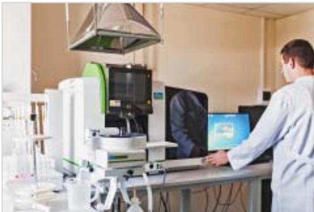
Рис. 7. Атомно-абсорбционный спектрометр серии PinAAcle 900T (PerkinElmer, США)
