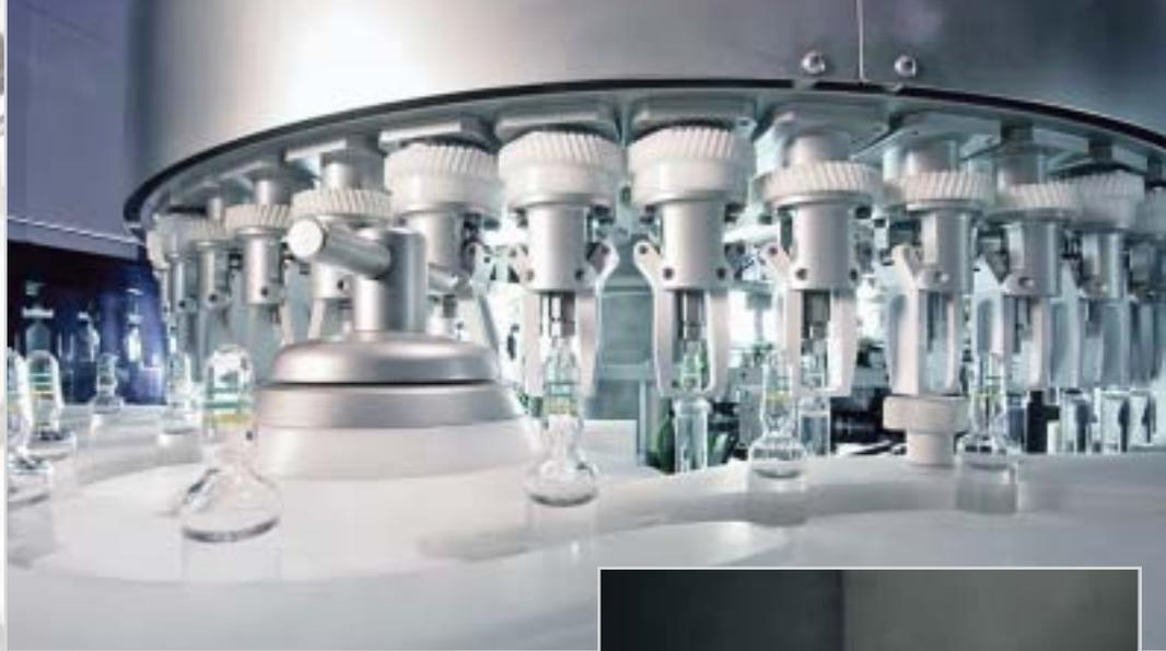
Поляризацию света применяют для уменьшения процента ложного брака из-за наличия пузырьков воздуха в продукте. Изображения и свет могут фокусироваться на различных областях контейнера в целях ограничения параметров инспекции в зависимости от особенностей движения частиц различного материала и размера.
