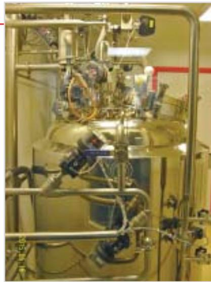
*Рис. 2. Реактор украинского производства, оснащенный импортными контрольно-измерительными приборами на участке производства инъекционных растворов и лиофилизатов во флаконах*
