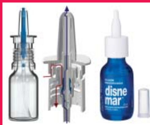
Рис. 3. Классическая серия: слева трехмерная модель помпы назального спрея на основе рецептур с консервантом, вкладыш и шаровой клапан выделены синим цветом. Посередине изображено движение солевого раствора (синяя стрелка) после активации помпы из трубки подачи через дозирочную камеру и насадку. Красной стрелкой указано движение продувочного воздуха. В обоих путях циркуляции системы не предусмотрены меры предотвращения бактериальной контаминации
