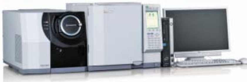
Фото № 1. Газовый хромато-масс-спектрометр с тройным квадруполом SHIMADZU модели GCMS-TQ8040
