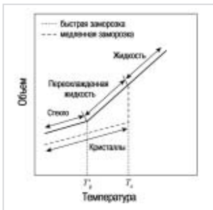
Рис. 8. Сравнение кристаллизации и стеклования материала
