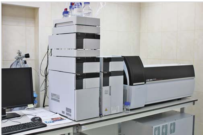
Фото № 2. Жидкостный хромато-масс-спектрометр SHIMADZU с тройным квадруполем модели LCMS-8040
