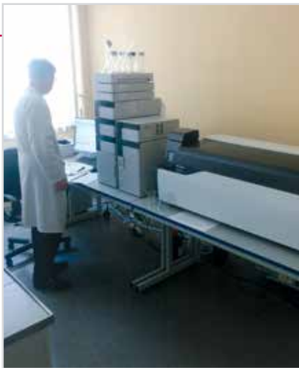
Фото № 2. Измерения на жидкостном тандемном хромато-масс-спектрометре модели LCMS-8050 производства корпорации SHIMADZU
