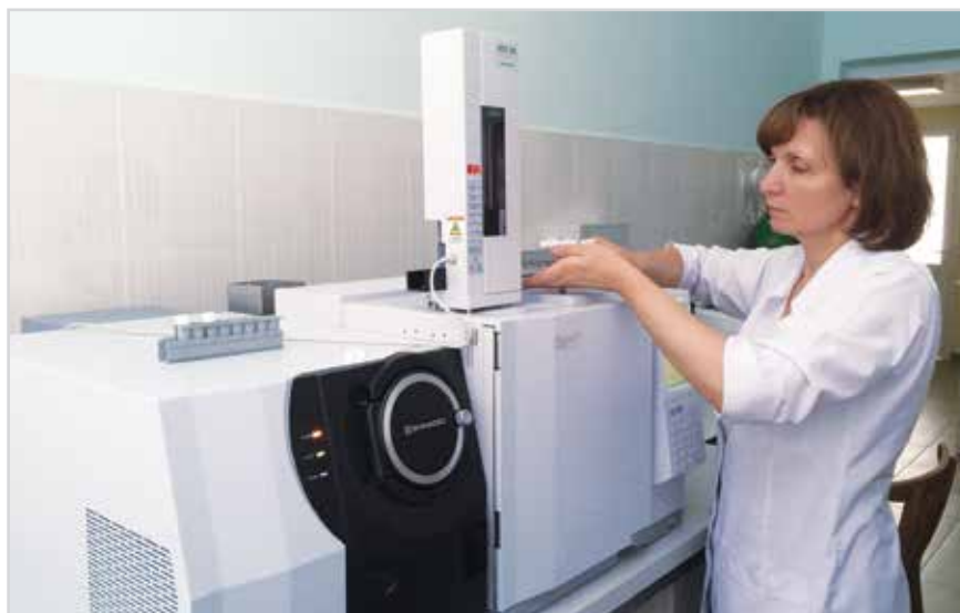
Фото № 3. Измерения на газовом тандемном хромато-масс-спектрометре модели GCMS-TQ8040 производства корпорации SHIMADZU
