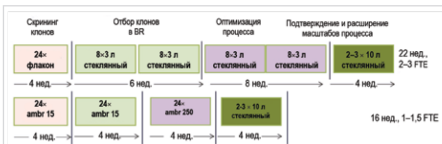
Рис. 4. Разработка процесса с использованием автоматизированных микро- и мини-биореакторов
