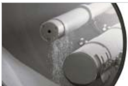
Рис. 4. Устройство для дозирования пленкообразующего порошка в установке GS HT-HE-HP производства компании IMA (слева) и принципиальная схема образования пленки методом плавления
