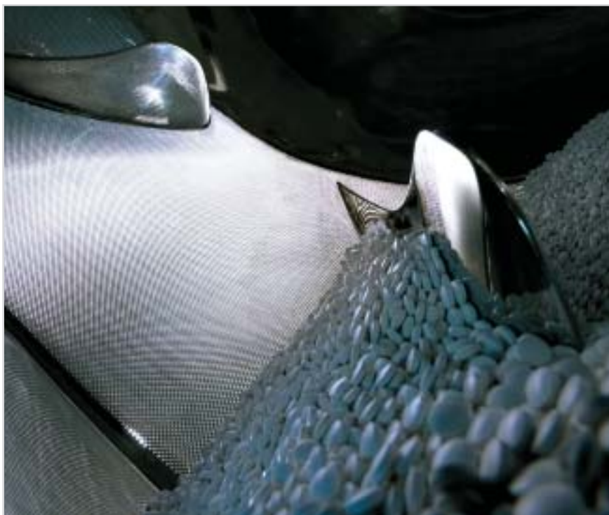
Внутренняя поверхность перфорированного барабана Perfima с таблетками
