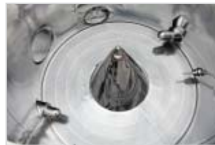
Рис. 7. Воздухораспределительный диск с расположением форсунок, обеспечивающих тангенциальное распыление в установке Bohle Uni Cone BUC
