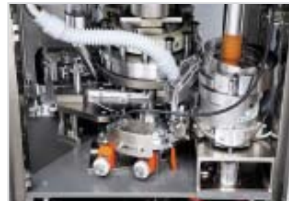
Рис. 9. Модуль таблеточного прессы производства компании Kikusui для реализации «таблетки в таблетке»
