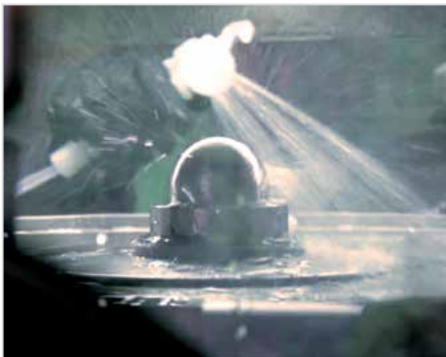
При помощи ручных распылительных форсунок операторы имеют доступ ко всем компонентам зоны фасовки и могут гарантированно удалить все опасные типы пыли
