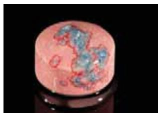
Рис. 4. Ядро состава № 3 после воздействия капли кислоты
