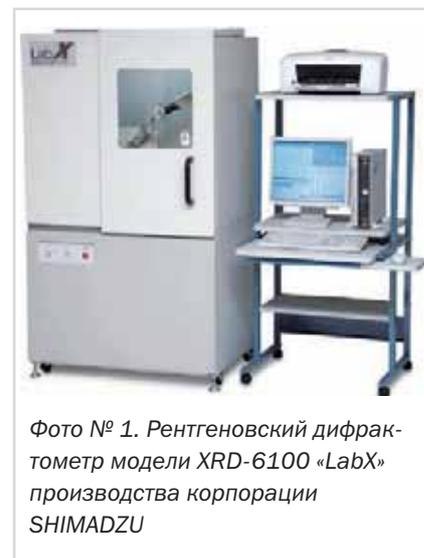
Фото № 1. Рентгеновский дифрактометр модели XRD-6100 «LabX» производства корпорации SHIMADZU
