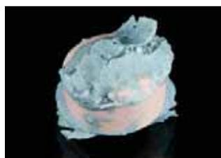
Рис. 3. Ядро состава № 2 после воздействия капли кислоты
