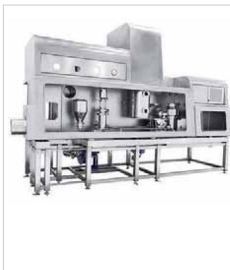
Передняя дверь для доступа к предварительной камере и камере грануляции движется в вертикальной плоскости в автоматическом режиме. Она снабжена весовой системой с опцией обнуления предыдущих значений.
