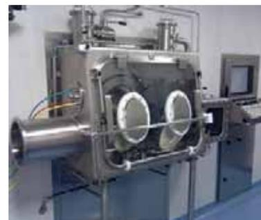
Полностью герметичный коагтер LAB30 в изоляторном исполнении снабжен предварительной камерой для загрузки таблеток и автоматической системой для их выгрузки, работает в автоматическом режиме, оснащен WIP-системой и системой контроля ПЛК-ПК.
