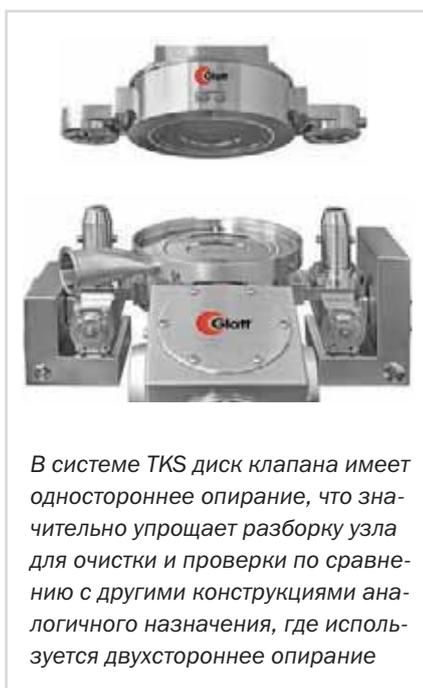
В системе TKS диск клапана имеет одностороннее опирание, что значительно упрощает разборку узла для очистки и проверки по сравнению с другими конструкциями аналогичного назначения, где используется двухстороннее опирание
