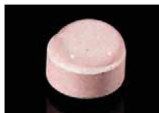
Рис. 5. Ядро состава № 4 после воздействия капли кислоты
