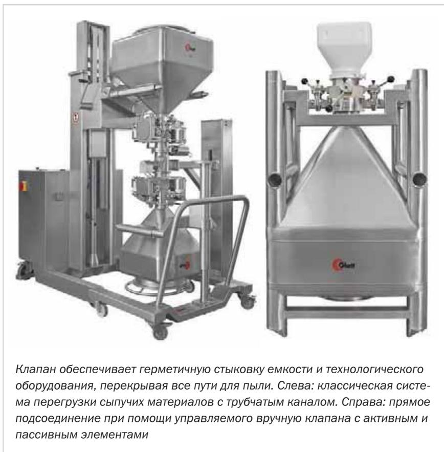
Клапан обеспечивает герметичную стыковку емкости и технологического оборудования, перекрывая все пути для пыли. Слева: классическая система перегрузки сыпучих материалов с трубчатым каналом. Справа: прямое подсоединение при помощи управляемого вручную клапана с активным и пассивным элементами
