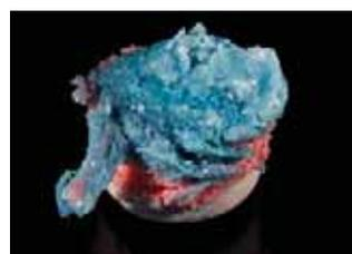
Рис. 2. Ядро состава № 1 после воздействия капли кислоты
