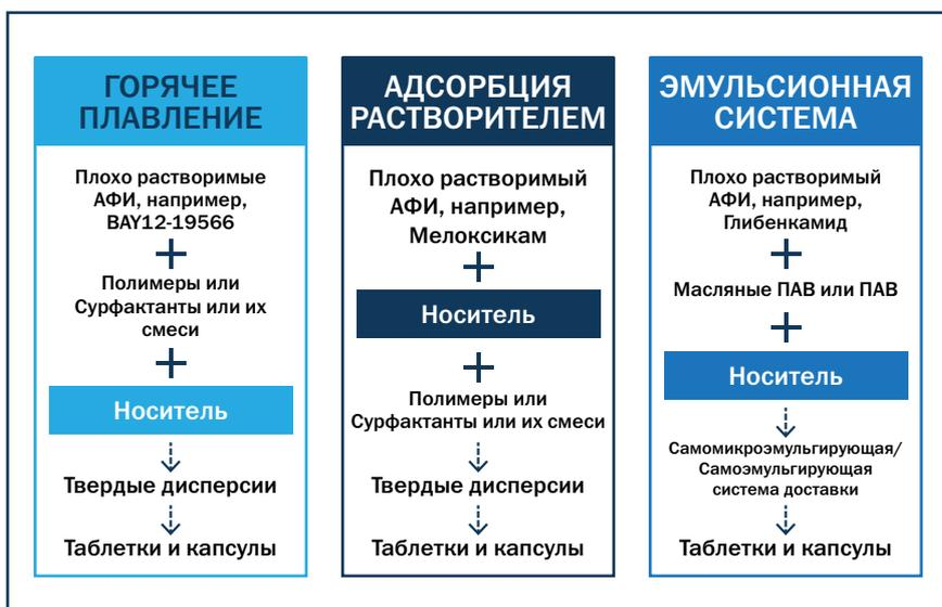
Рис. 2. Три метода применения адсорбента-носителя в различных твердых дисперсиях
