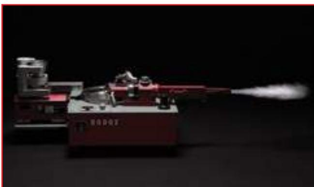
*RODOS – модуль воздушного диспергирования порошков*
