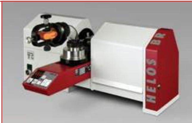
HELOS & INHALER – лабораторный гранулометр для анализа аэрозолей
