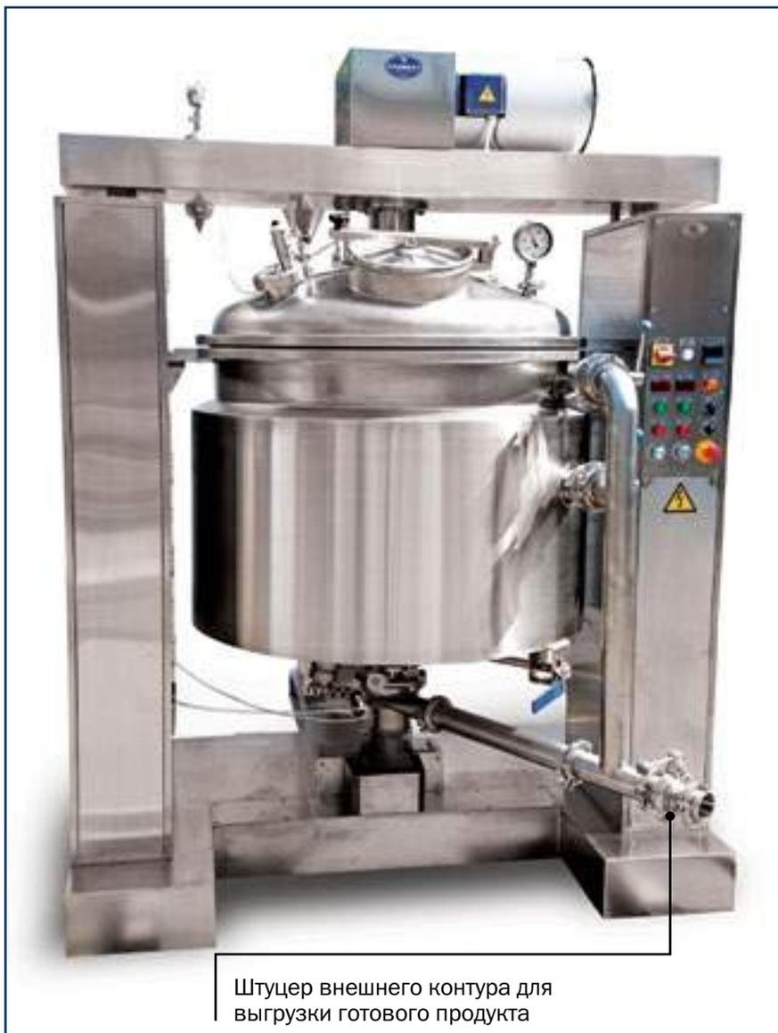
Штуцер внешнего контура для выгрузки готового продукта
