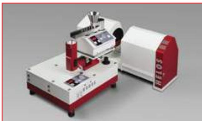
*HELOS & RODOS – лазерный дифракционный анализатор размеров частиц*
