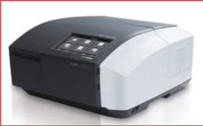
Фото № 5. Спектрофотометр УФ-видимого диапазона модели UV-1900
