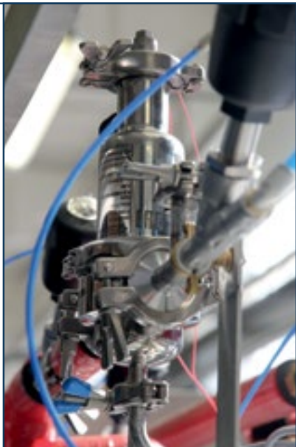
Рис. 6. Воздушный фильтр в стерилизаторах фармацевтического класса (GMP)
