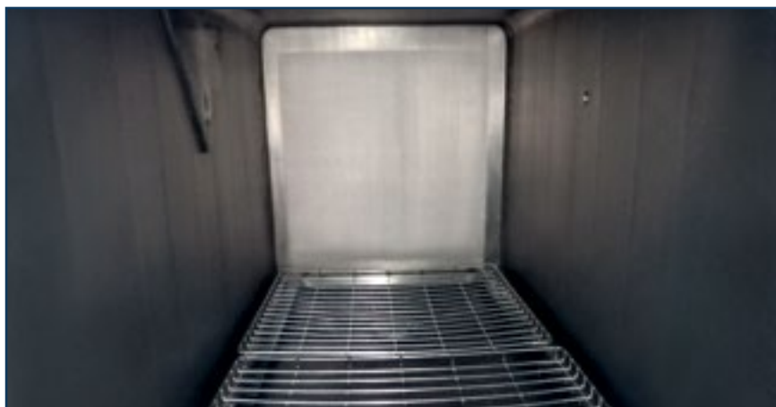
Рис. 2. Исполнение камеры в стерилизаторе фармацевтического класса (GMP)
