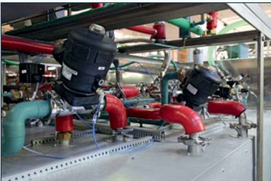
Рис. 4. Исполнение запорных вентилей и элементов трубной обвязки в стерилизаторах фармацевтического класса (GMP)
