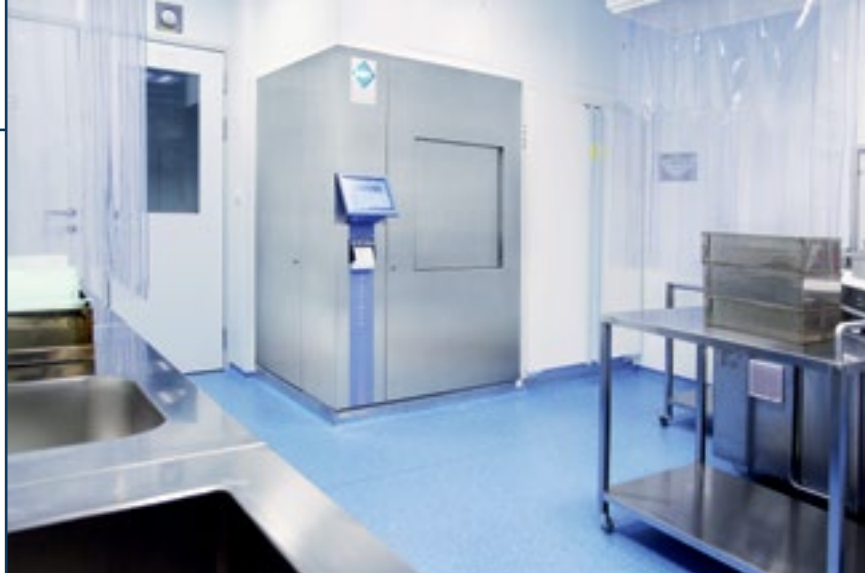
Рис. 7. Стерилизатор фармацевтического класса (GMP) на месте установки
