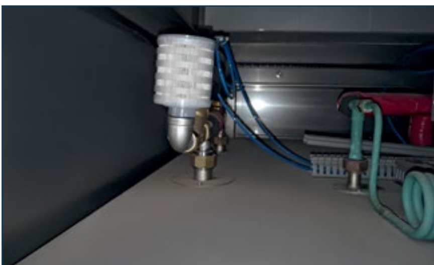
Рис. 5. Воздушный фильтр в лабораторных стерилизаторах
