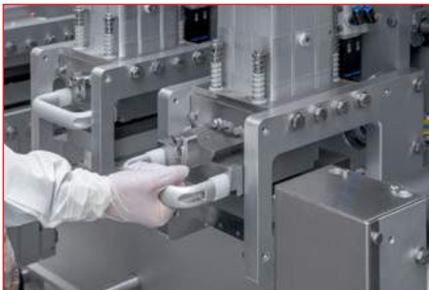
Смена насадок для резки на машине OPTIMA TDC 125
