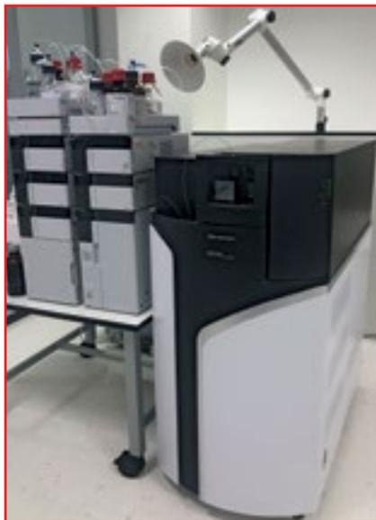
Фото № 1. Жидкостный Q-TOF хромато-масс-спектрометр модели LCMS-9030
