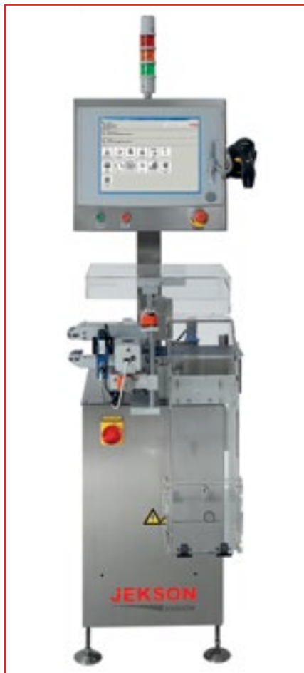
Компактная машина для сериализации REETRAK™ S120, ширина которой составляет 501 мм
