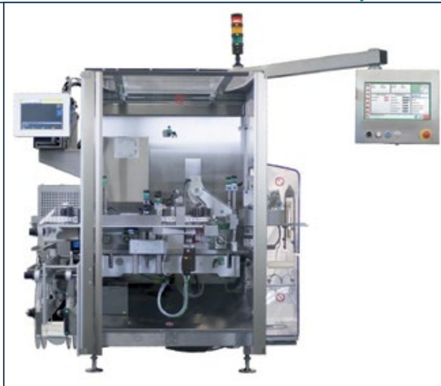
BL A415 – классика для маркировки и нанесения этикеток контроля вскрытия
