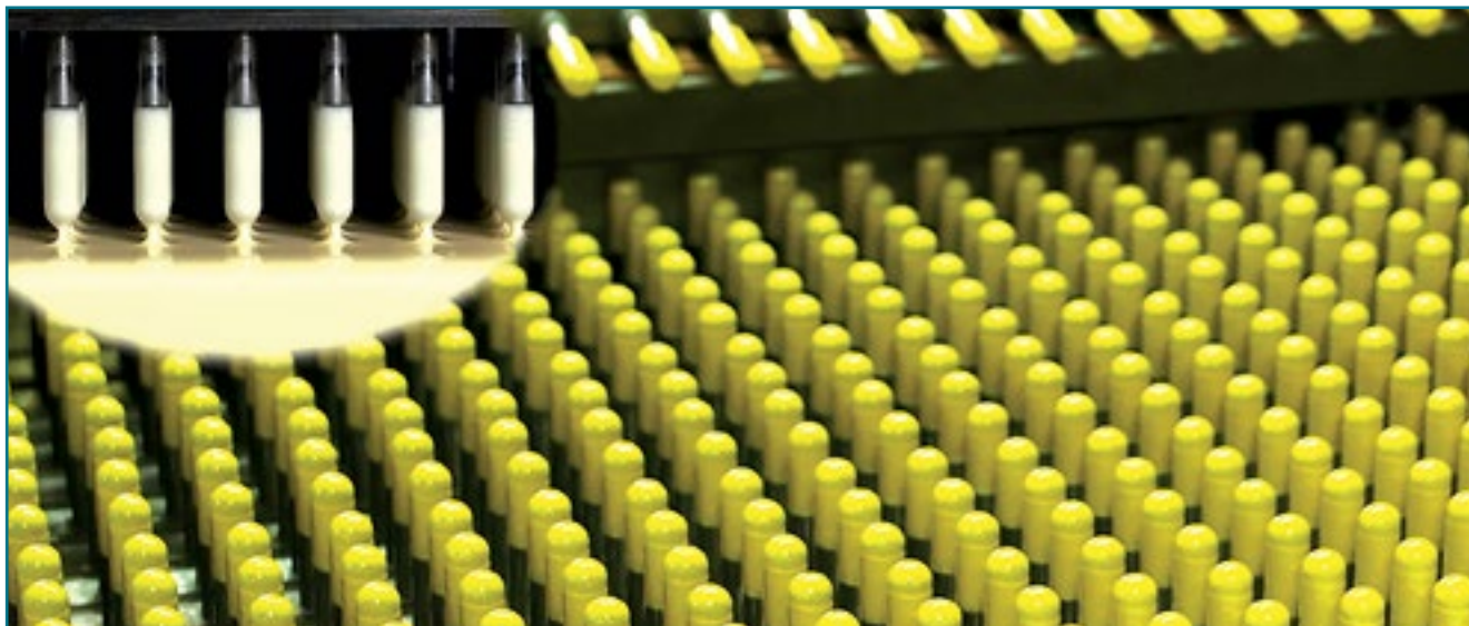
Рис. 2. Погружение форм в желатиновую массу и сушка частей капсул
