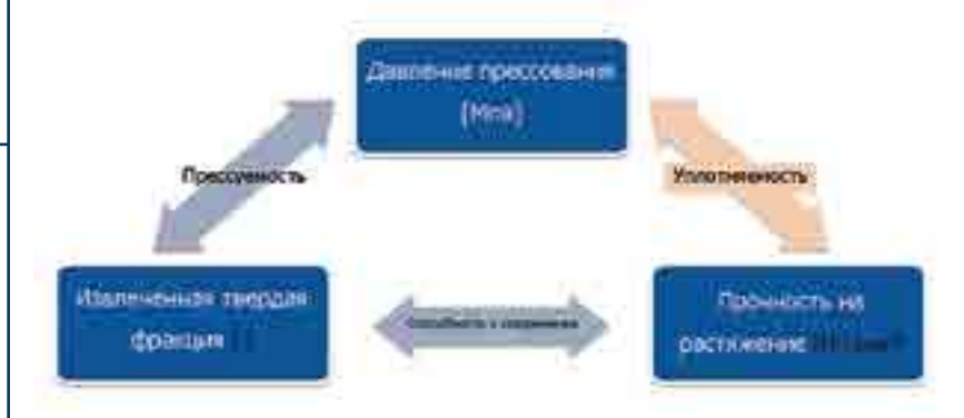
Рис. 1. Взаимосвязь уплотняемости, прессуемости и способности к соединению
