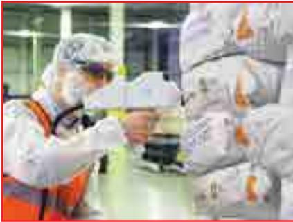
Рис. 3. Идентификация партии сырья на складе с помощью **Agilent Rapid**
